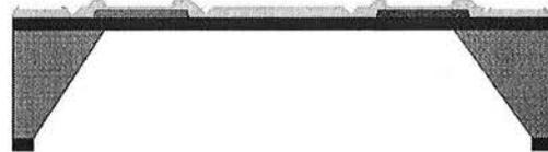
Etape 20 : Attaque chimique de la couche de chrome superficielle afin d'avoir un contact en or.
