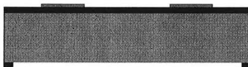
Etape 5 : Attaque chimique du silicium polycristallin en utilisant pour masque la couche Au/Cr puis attaque chimique de celle-ci.
