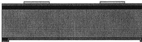
Etape 4 : Structuration de la couche Au/Cr par photolithographie et attaque chimique.
