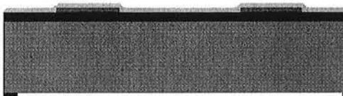
Etape 6 : Dépôt d'une couche de  $\text{SiO}_2$  par PECVD de 550 nm d'épaisseur servant de masque pendant l'implantation ionique de bore pour fabriquer les thermoéléments de type p.
