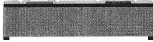
Etape 18 : Déposition d'une couche de passivation de  $\text{SiN}_x$  par PECVD de 100 nm.
