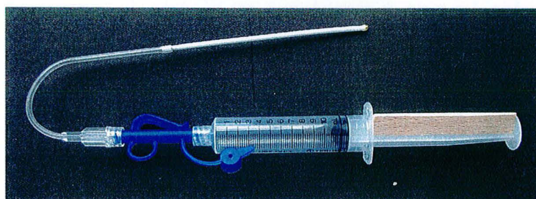
Photographie 4.1 : Détail du dispositif de prélèvement par bougie poreuse
