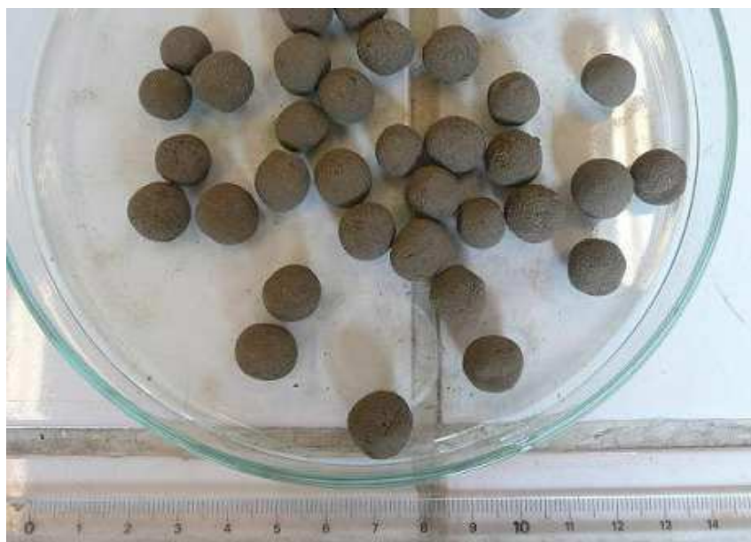
Figure 2.5 : Boulettes d'argile du Cameroun, façonnés à la main puis séchés à 35°C.
