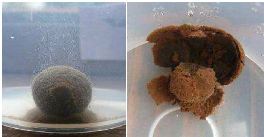
Figure 5.4 : Boulette d'argile naturelle non cuite en cours de désagrégation et aspect d'une boulette d'argile naturelle cuite à 500°C et laissée 48h dans l'eau après pression mécanique.
