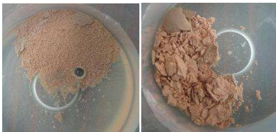
Figure 5.3 : Aspect d'une boulette de kaolinite et poudre de verre cuite à 400°C et d'une boulette de kaolinite et poudre de verre cuite à 500°C, après 48h d'immersion dans l'eau.
