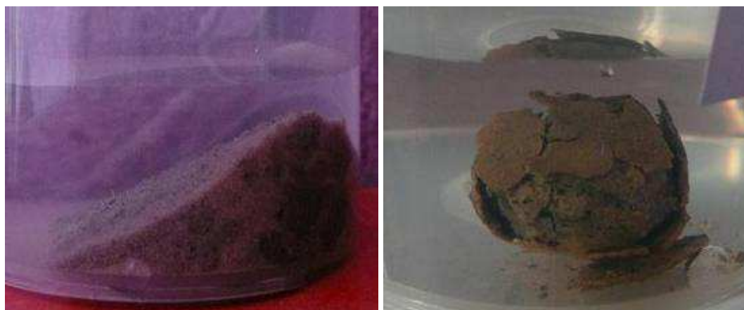
Figure 5.2 : Aspects d'une boulette de kaolinite et bentonite cuite à 500°C et d'une boulette de kaolinite et bentonite cuite à 600°C), après 48h d'immersion dans l'eau.
