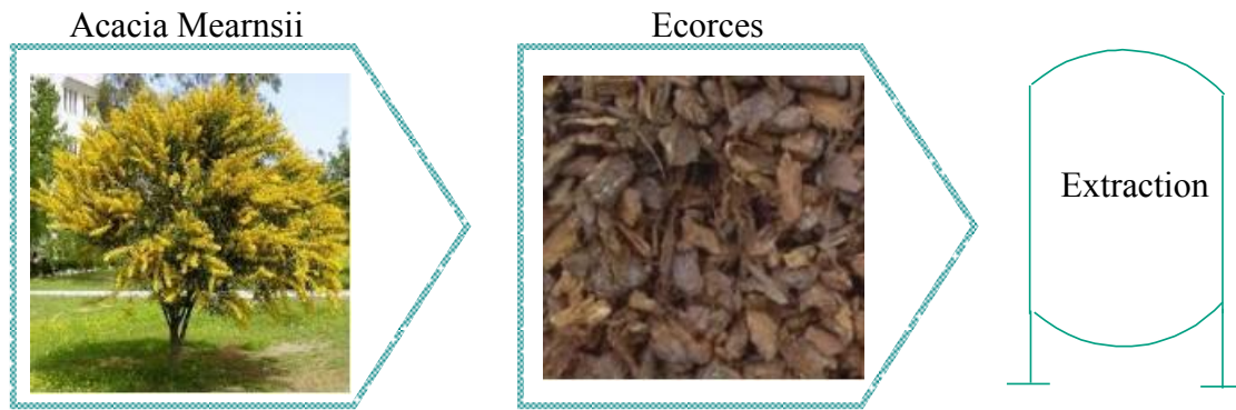
Figure 4. Voie d'obtention des extraits tanniques.
