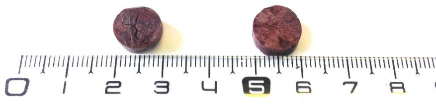
Figure 59. Cryogels de tanin-formaldéhyde : CrTF18%-8 et CrTF 26%-4.
