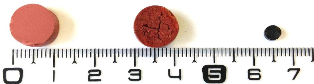
Figure 28. Produits du séchage de la formulation TF6%-2 : (a) supercritique à CO 2 (aérogel) ; (b) lyophilisation (cryogel) et sous-critique (xérogel).
