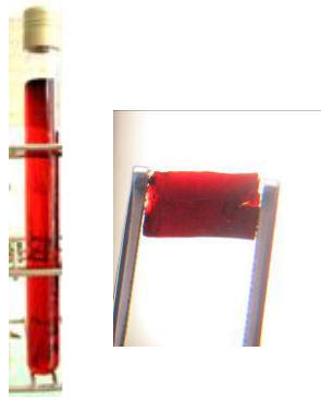
Figure 29. Hydrogel RF et aérogel correspondant séché dans CO 2 supercritique.
