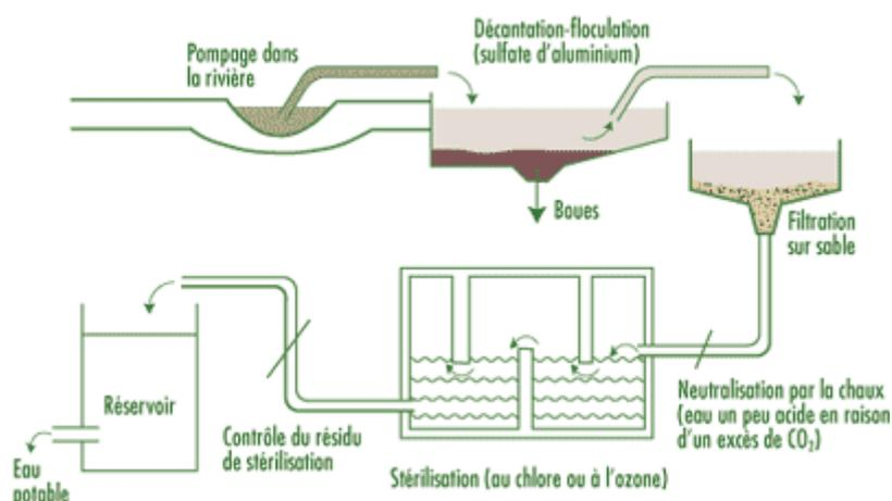
**Figure 1. Schéma simplifié du fonctionnement d'une station de potabilisation des eaux ([http://crdp.ac-amiens.fr/enviro/eau\\_maj\\_solution\\_p3.htm](http://crdp.ac-amiens.fr/enviro/eau_maj_solution_p3.htm)).**
