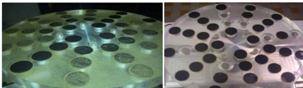
Figure 43. Vue macroscopique des disques tournant avant (A) et après (B) application d'une augmentation des contraintes hydrodynamiques (de 75 à 340 rpm) sur un biofilm d'eau potable de 60 jours.
