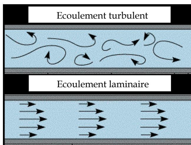
**Figure 13.** Représentation schématique d'un écoulement laminaire ou turbulent.
