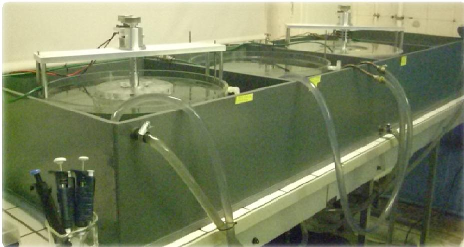
Figure 18 : Cuve de thermostatisation en PVC pouvant contenir quatre réacteurs à disque rotatif.
