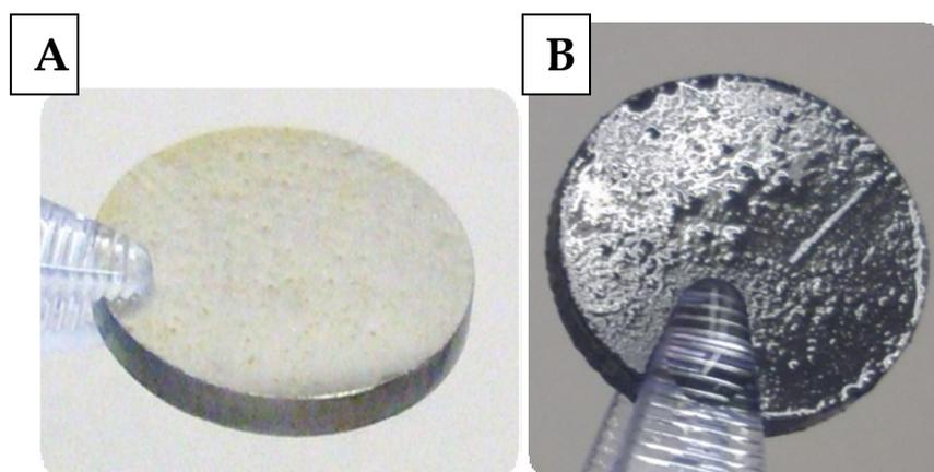
**Figure 29.** Coupons (1,8 cm de diamètre) d'inox 316L (A) et de PEHD (B) colonisés par un biofilm de 60 jours.
