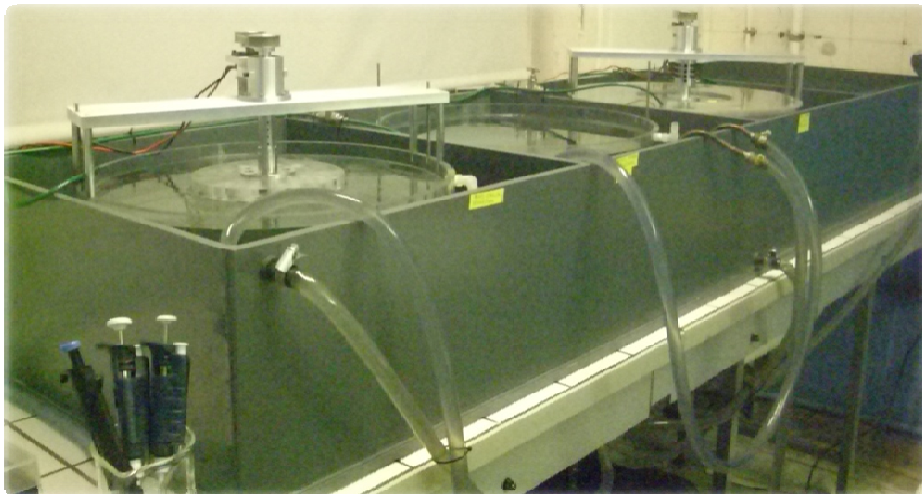
Figure 18 : Cuve de thermostatisation en PVC pouvant contenir quatre réacteurs à disque rotatif.
