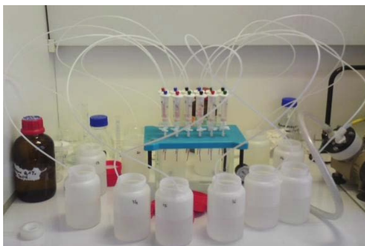
Figure II-14 : Schéma du montage de SPE pour l'extraction des composés perfluorés.
