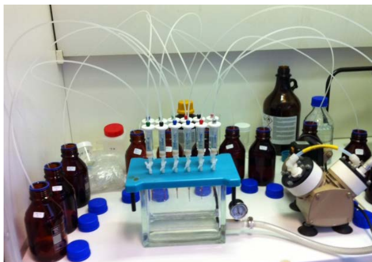
Figure II-11 : Schéma du montage de SPE pour l'extraction multi-résidus.
