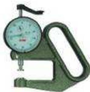
**Figure 39** : micromètre manuel (Messmer, Londres, Angleterre)
