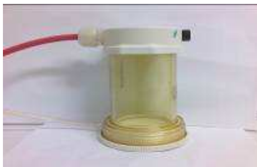
Figure 28 : système d'ultrafiltration Amicon-8200 pour éliminer les phénols, les peptides et les protéines de taille inférieure à 10 kDa présents dans la solution brute de la laccase
