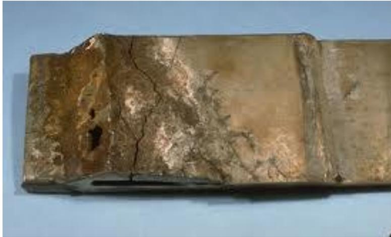
**Figure 23** : Vue d'une corrosion sous contrainte.
