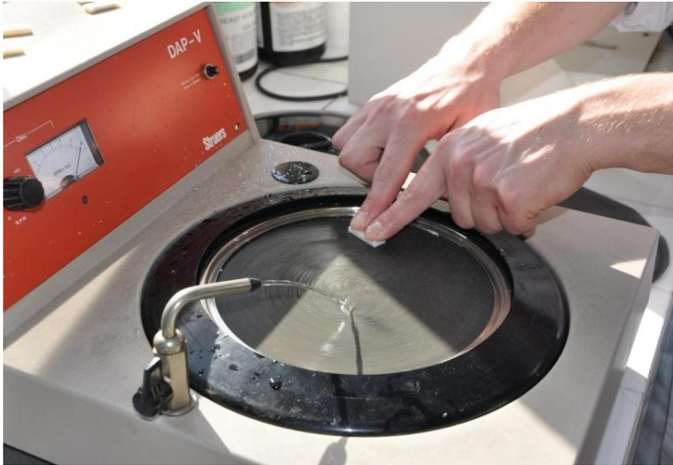
**Figure 64** : Photo du polissage des échantillons.
