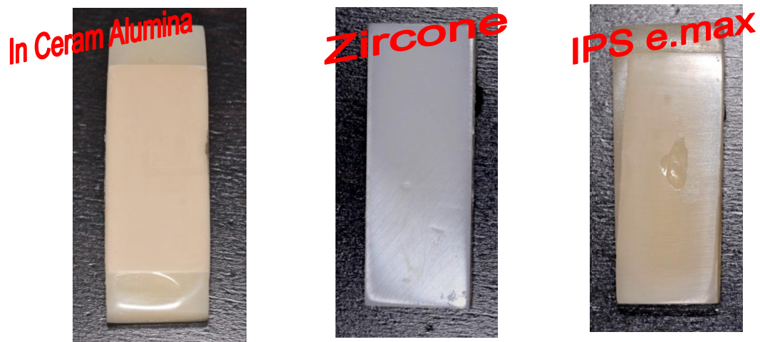
Figure 75 : Aspect des échantillons après action mécanique durant 14 jours (indenteur en émail naturel).
