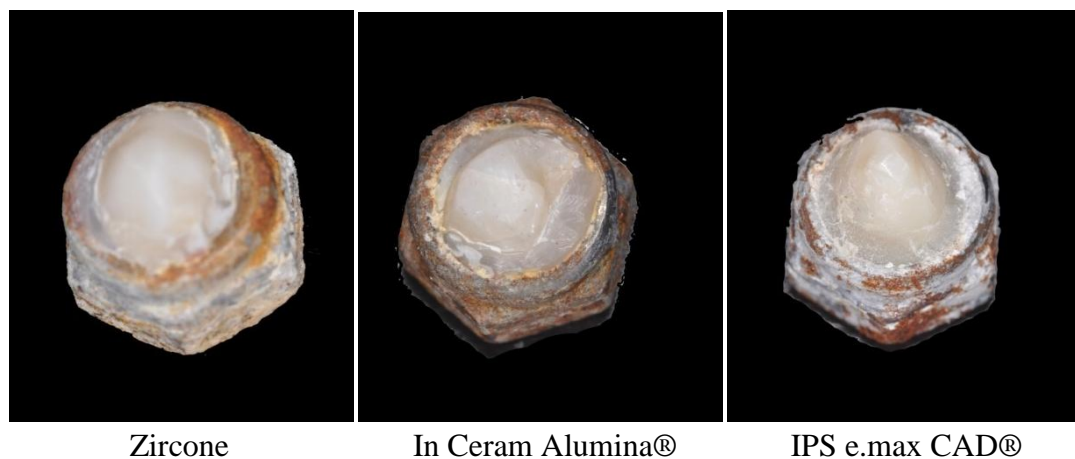
Figure 77 : Aspect des mêmes indenteurs en dent naturelle après leur passage 14 jours dans la machine d'usure.
