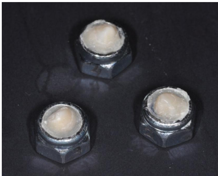
Figure 76 : Aspect des indenteurs en dent naturelle : cuspide de prémolaire maxillaire maintenue dans l'écrou avec de la résine chémopolymérisable.
