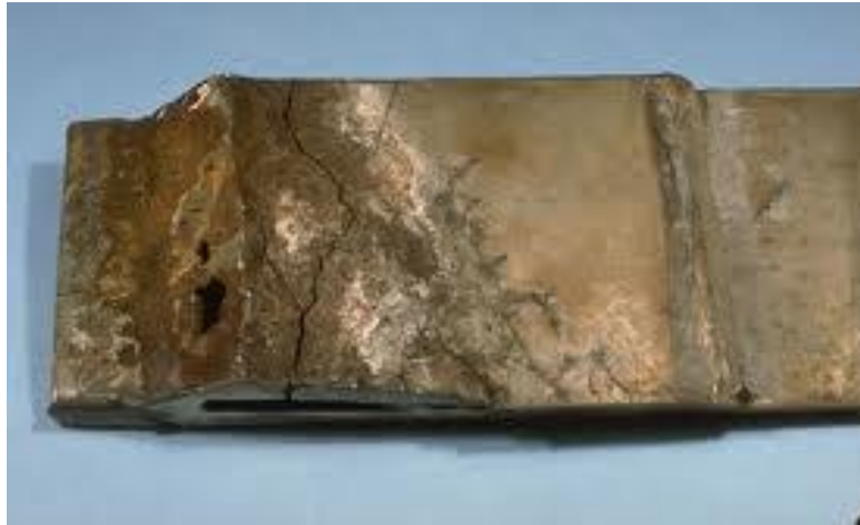
Figure 23 : Vue d'une corrosion sous contrainte.
