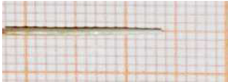
Figure. III.35: Fibre de LN congruent dopé 2% d'holmium tirée par \mu -PD.
