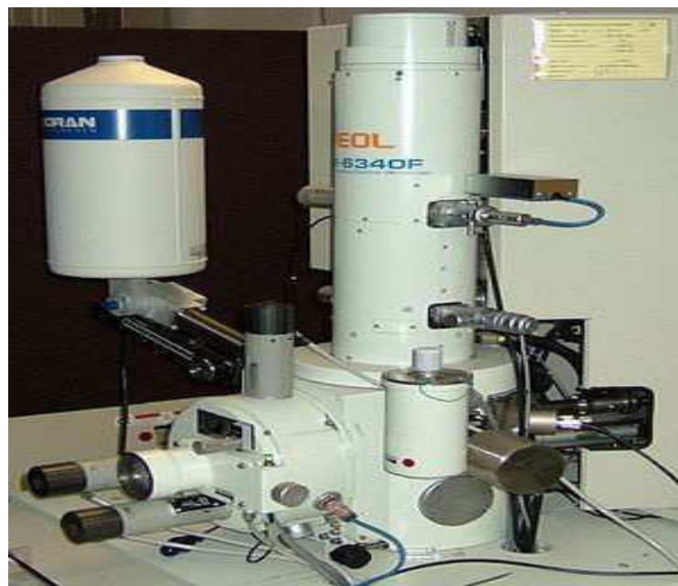
Figure II.12: Appareil de la Microscopie électronique à balayage.
