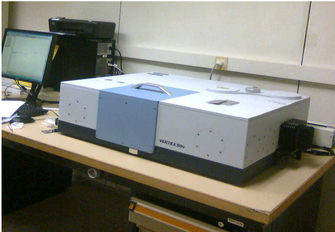
Figure II.17: Dispositif expérimental de spectroscopie d'absorption.
