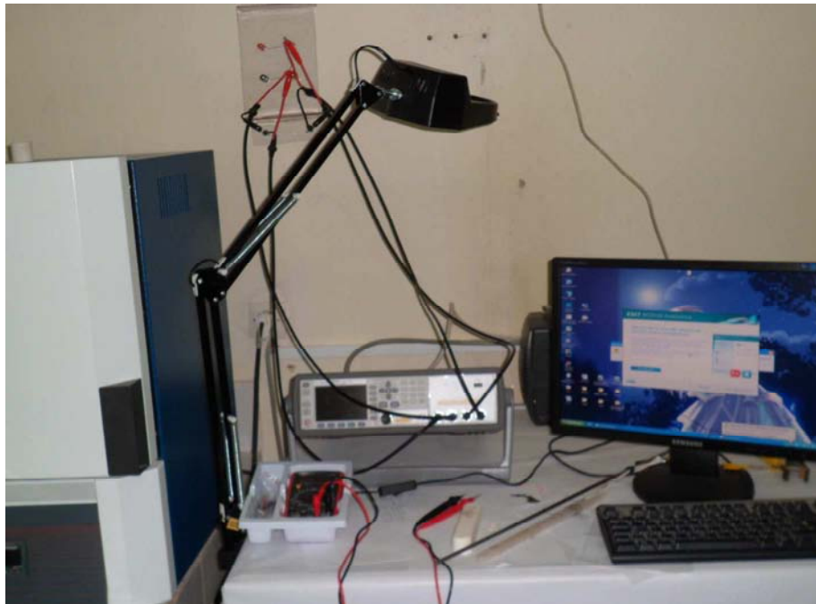
Figure II.18.a: Dispositif expérimental des mesures diélectriques.
