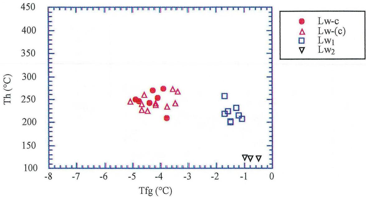
Fig. V-33 - Diagramme Tfg-Th des inclusions aqueuses et aquo-carboniques dans l'échantillon de micaschistes SM60
