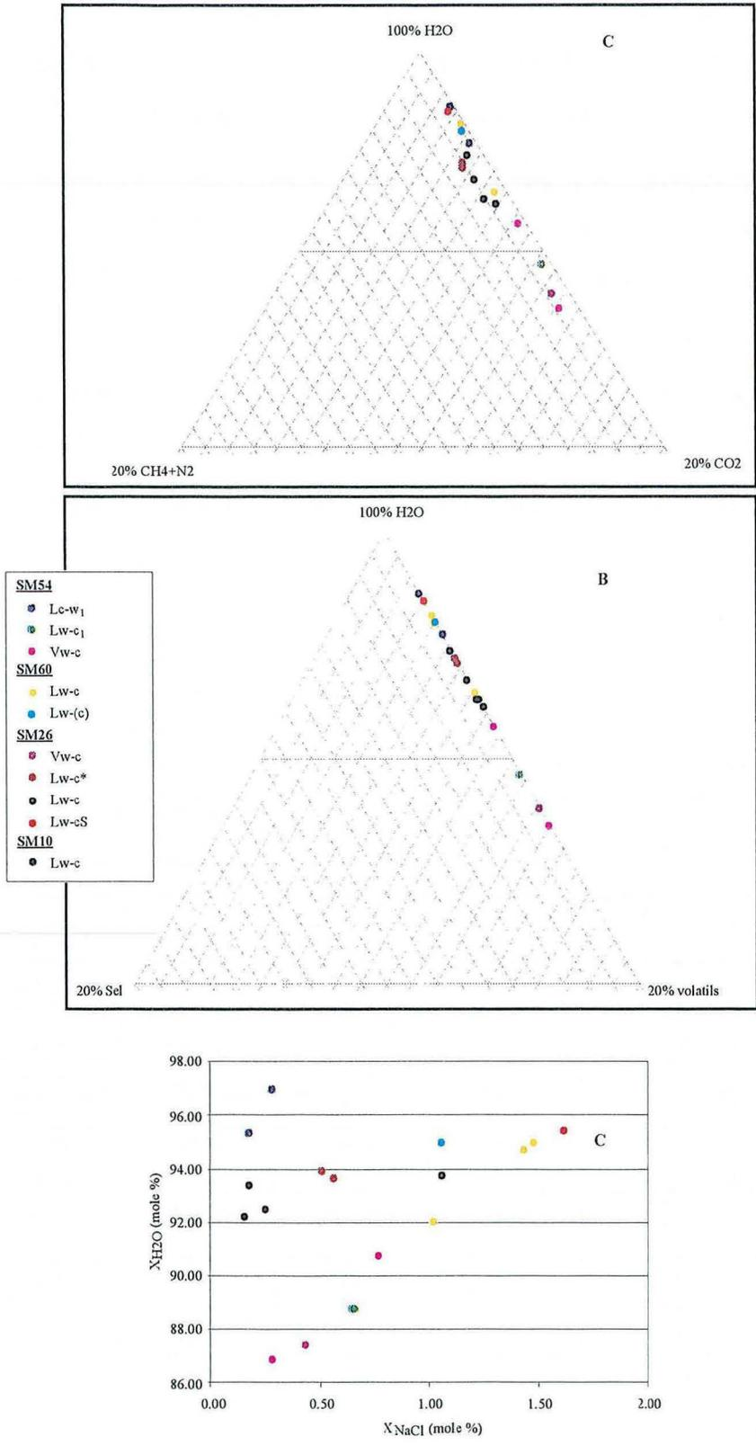
Fig. V-29 - Diagrammes ternaires H<sub>2</sub>O-CO<sub>2</sub>-CH<sub>4</sub>+N<sub>2</sub> (A) et H<sub>2</sub>O-volatils-salinité (B), et le diagramme binaire X<sub>H<sub>2</sub>O</sub>-X<sub>NaCl</sub> de la composition totale des inclusions fluides aquo-carboniques (en mole %)
