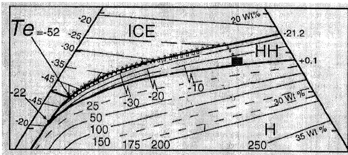
Fig. II-22 Projection des données de microthermométrie des inclusions Lw-cS (S : halite) de l'échantillon SM26, dans le diagramme ternaire NaCl-CaCl<sub>2</sub>-H<sub>2</sub>O (d'après Oakes et al., 1990 ; Williams-Jones et Samson, 1990 ; Vanko et al., 1992).
