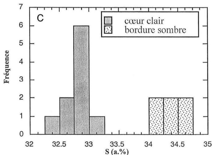
Fig. IV- 13 - Composition chimique des arsenopyrites dans le site du Maupas ;
