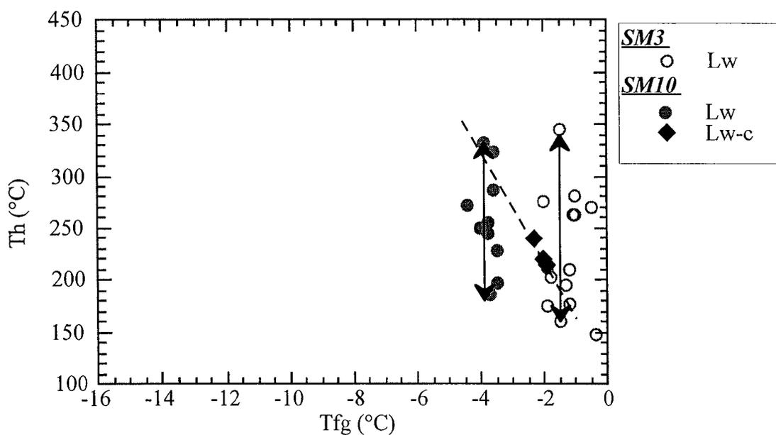
Fig. V-30 - Diagramme  $T_{fg}$ - $T_h$  des inclusions aqueuses et aquo-carboniques dans le secteur du Maupas (SM3) et de Puy-des-Angles (SM10)
