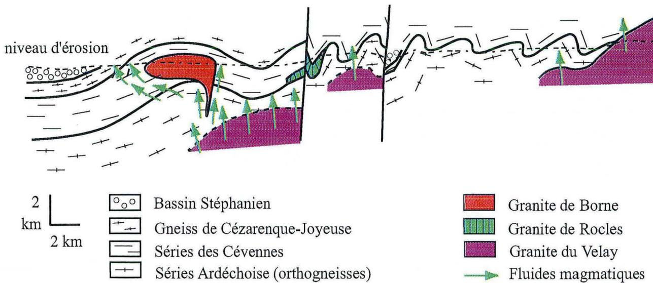
Fig. VI-3 : Modèle de la source des fluides aurifères: cas des Cévennes
