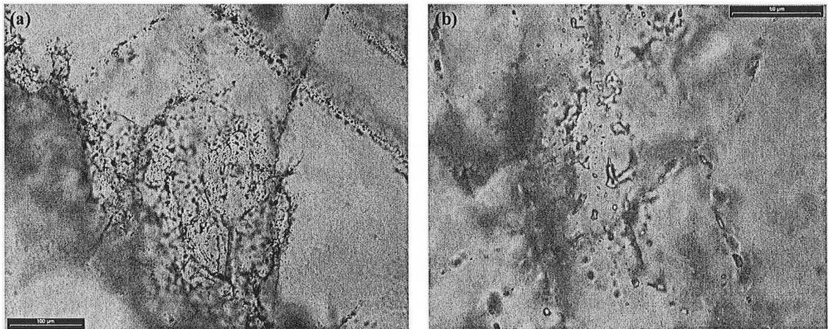
Fig. II-7 : Photographie des joints de grains (a) avec des figures de décrépitation (b) dans le quartz (CFM48).
