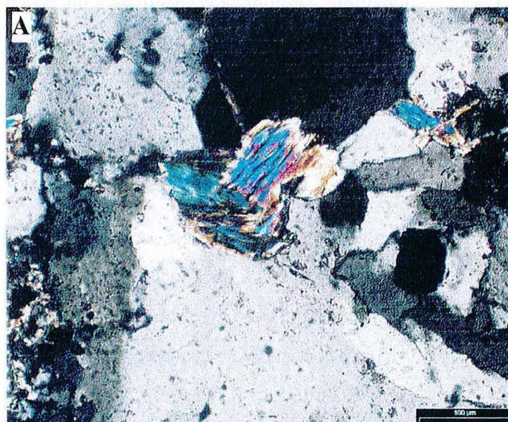
Fig. IV-7 - Les différents types de phyllites (LP) dans l'échantillon SM9 (site de Puy-des-Angle).
