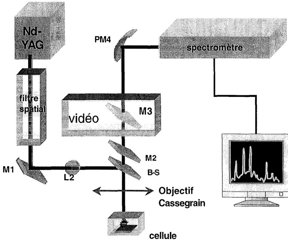
Fig. III-1 : schéma du dispositif de la spectrométrie LIBS (Fabre et al., 1999).
