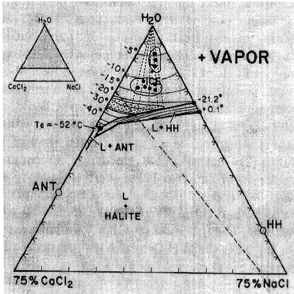
Fig. V-4 - Projection des données de microthermométrie des inclusions Lw de l'échantillon SM54, dans le diagramme ternaire NaCl-CaCl<sub>2</sub>-H<sub>2</sub>O (Vanko et al., 1988)
