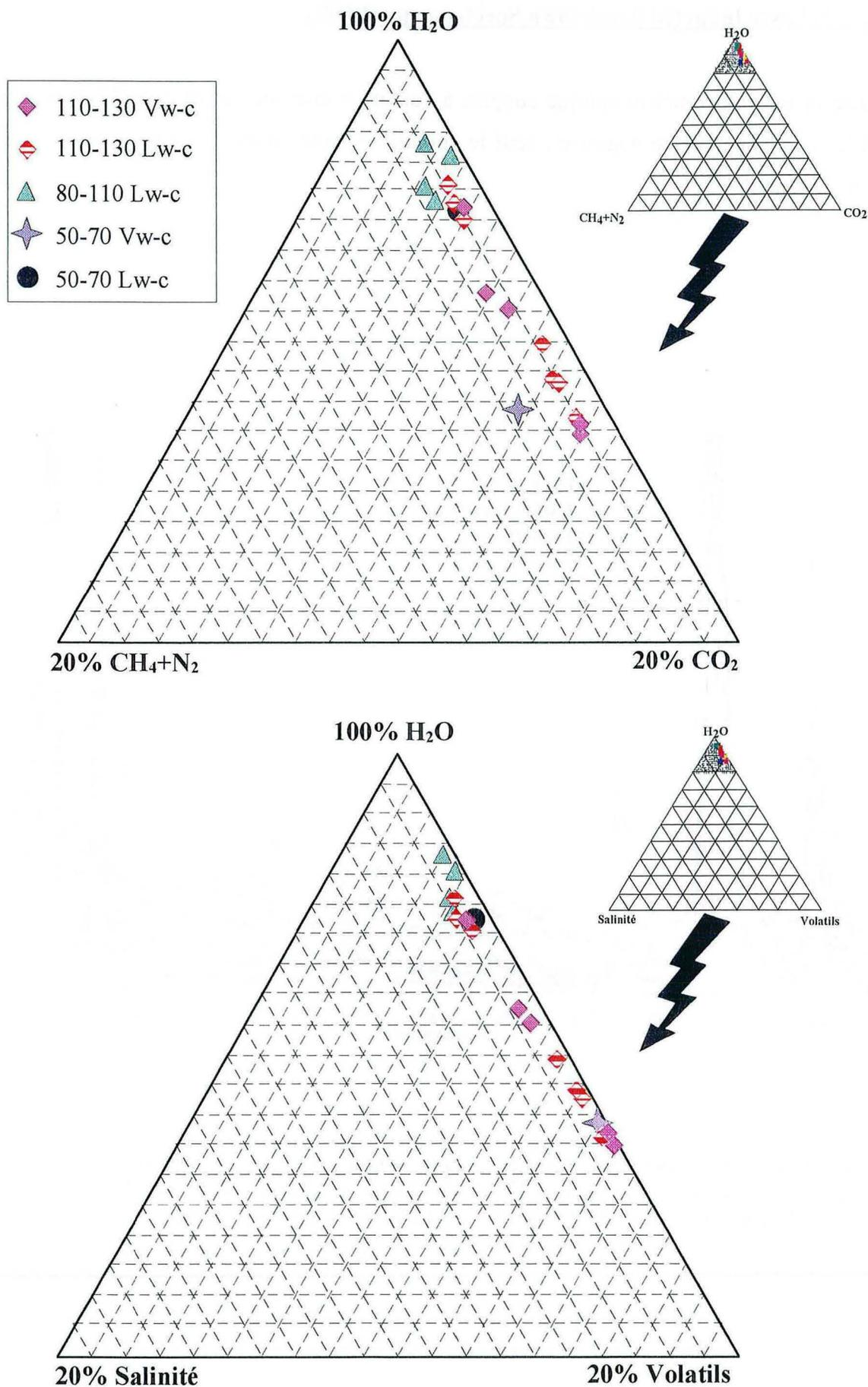
Fig. III-20: Diagramme ternaire H<sub>2</sub>O-CO<sub>2</sub>-(CH<sub>4</sub>+N<sub>2</sub>) et H<sub>2</sub>O-Volatils-Salinité de la composition totale des inclusions fluides aquo-carboniques
