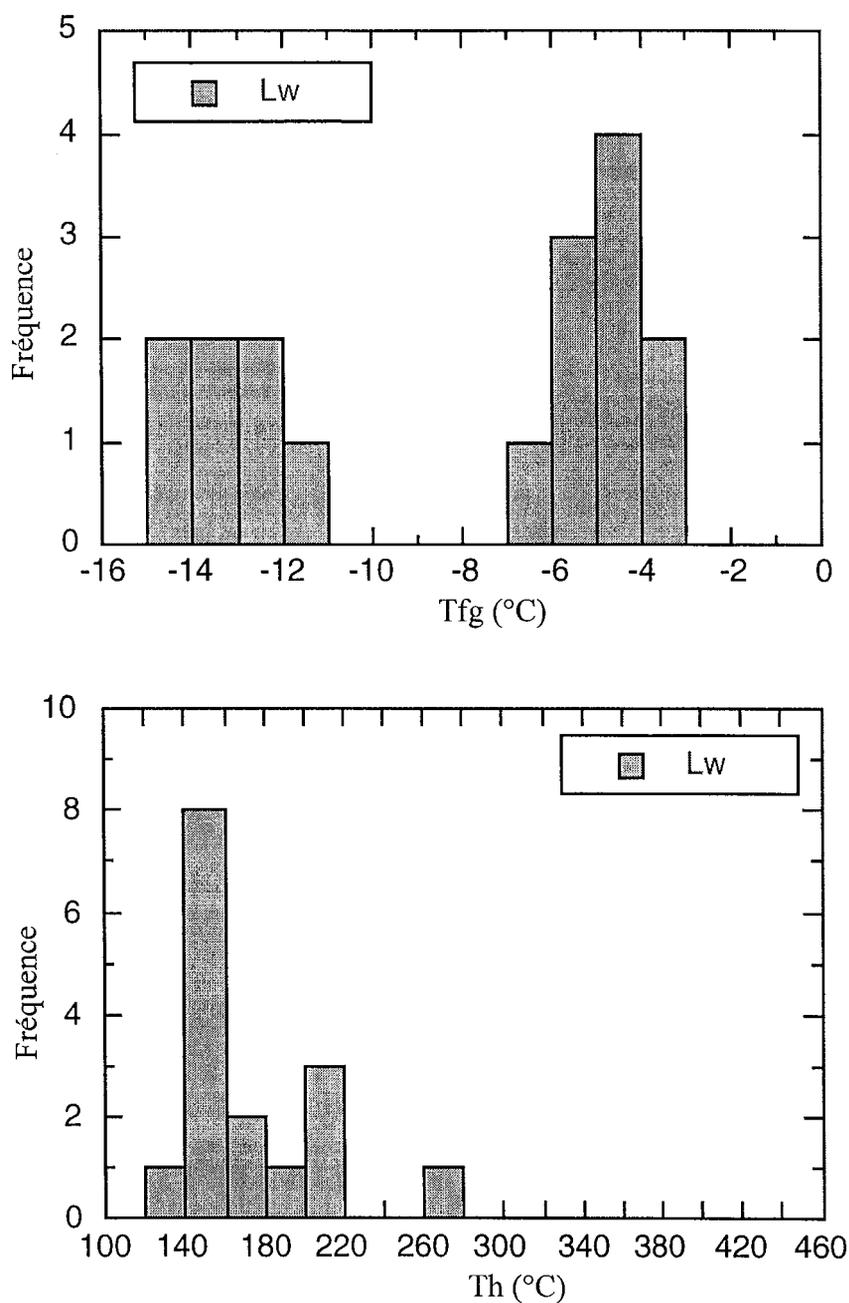
Fig. V-5 - Histogrammes de fréquence des Tfg (A) et des Th correspondantes (B) dans les inclusions aqueuses de l'échantillon SM54
