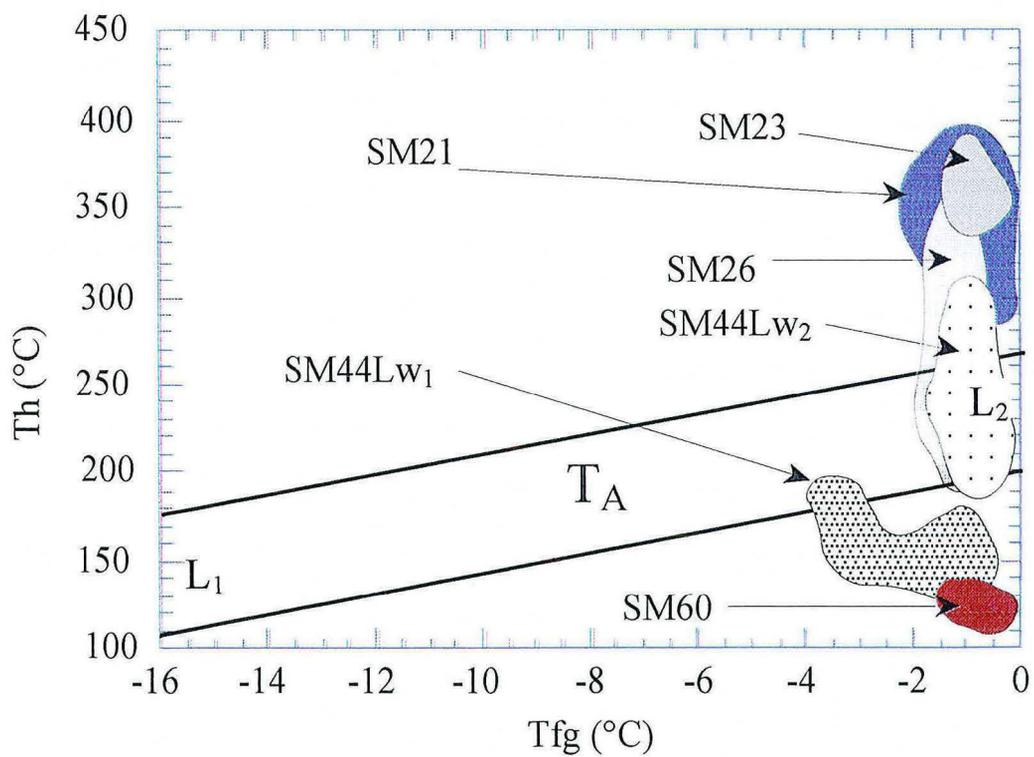
Fig. V-38 - Synthèse des données des T<sub>fg</sub>-Th de l'ensemble des inclusions aqueuses, mettant en évidence le "trend" T<sub>A</sub> (L1-L2) et un groupe de fluide de faible salinité hors ce "trend"
