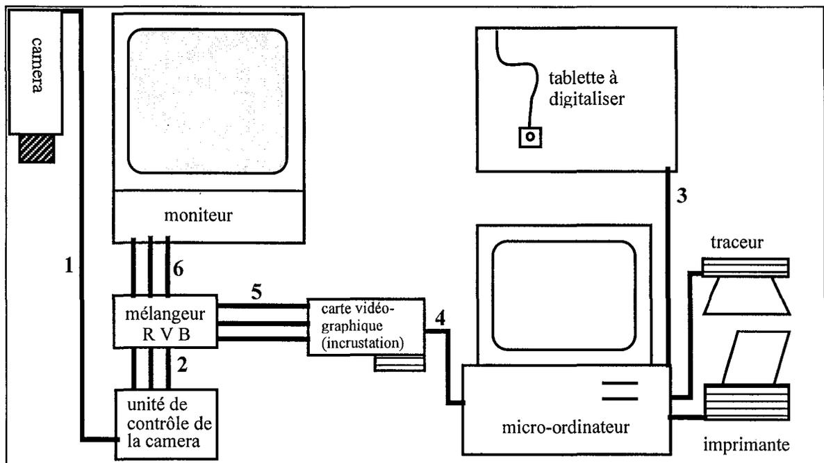
Fig. II-4 : Système d'incrustation vidéographique (Lapique et al., 1988).
