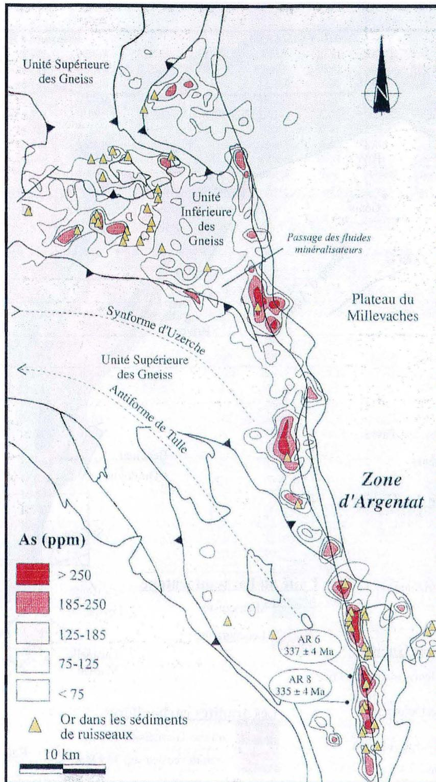
Fig. I-5 : Carte des anomalies As des sédiments de ruisseaux soulignant le paléochamps hydrothermal de la faille d'Argentat (in Roig et al., 1997, d'après Bouchot et Marroncle, 1992)
