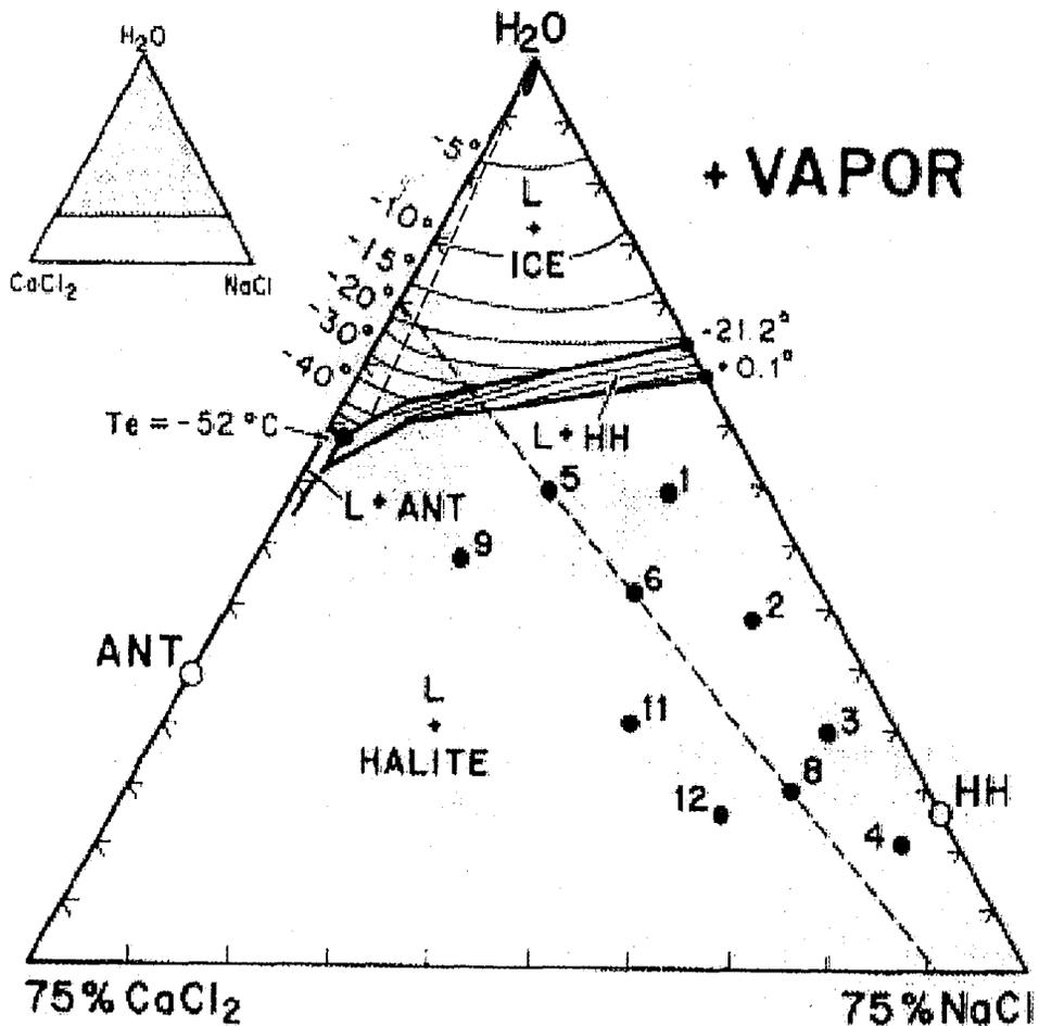
Fig. V-22 b - Diagramme ternaire  $H_2O-NaCl-CaCl_2$  permettant le calcul de la composition des inclusions Lw dans l'échantillon SM26 (Vanko et al., 1988).
