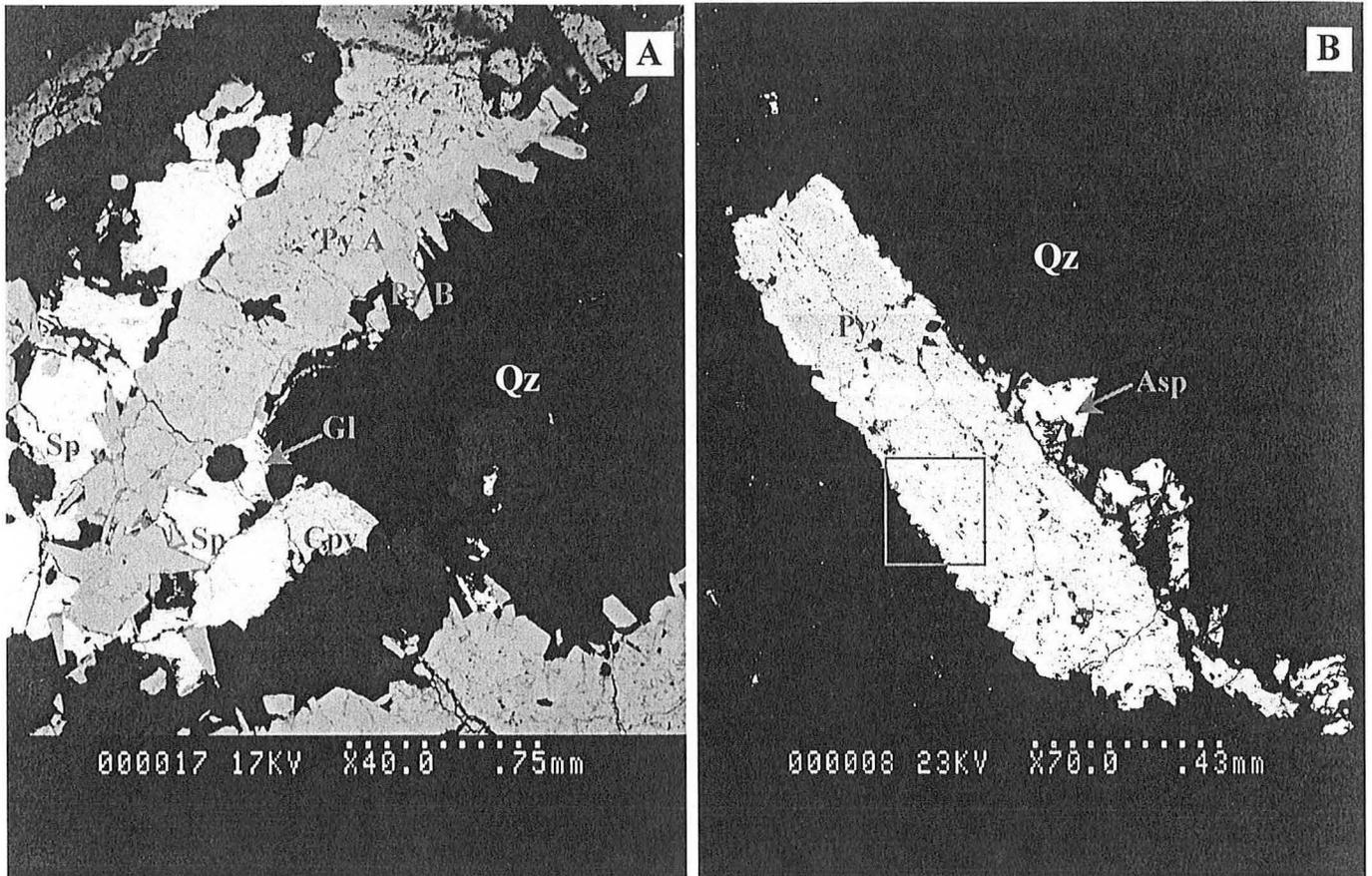
Fig. IV- 27 - Photographies MEB des sulfures de l'échantillon SM23, montrant les relations entre les différentes phases ; Asp : arsenopyrite ; Cpy : chalcopyrite ; Gl: galène ; Sp : sphalérite ; Py : pyrite avec PyA correspondant au cœur et PyB des surcroissances en aiguilles sur le bord ; Qz : quartz.
