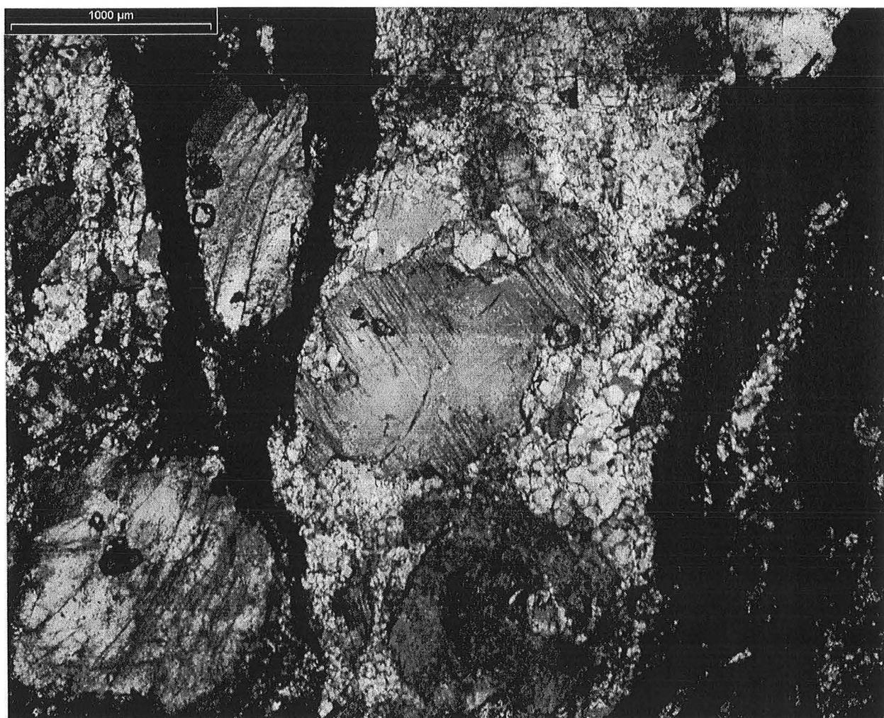
*Fig. V-15 - Photographie au microscope optique montrant la structuration et la minéralogie de la tonalite SM46 (lumière polarisée)*
