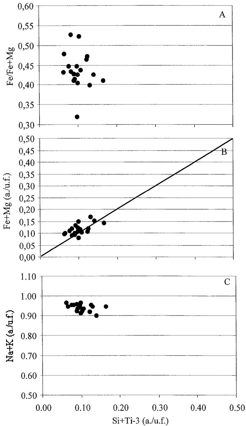
Fig. IV-28 - Composition chimique des phengites du site AR116 (échantillon SM23).
