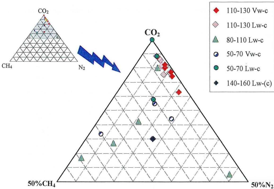
Fig. III-19. Diagramme ternaire CO<sub>2</sub>-CH<sub>4</sub>-N<sub>2</sub> de la composition des phases volatiles obtenue par microspectroscopie Raman
