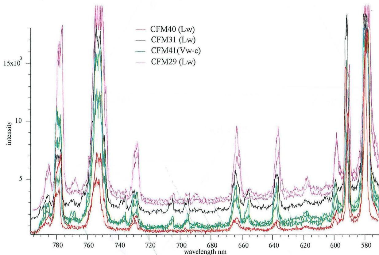
Fig. III-21 Spectres d'ablation laser des inclusions aqueuses et aquo-carboniques dans différents échantillons (CFM31 PIF à N80-110°E ; CFM41 PIF à N110-130°E, CFM29 dans PIF à N170-30°E, direction non déterminée pour CFM40).
