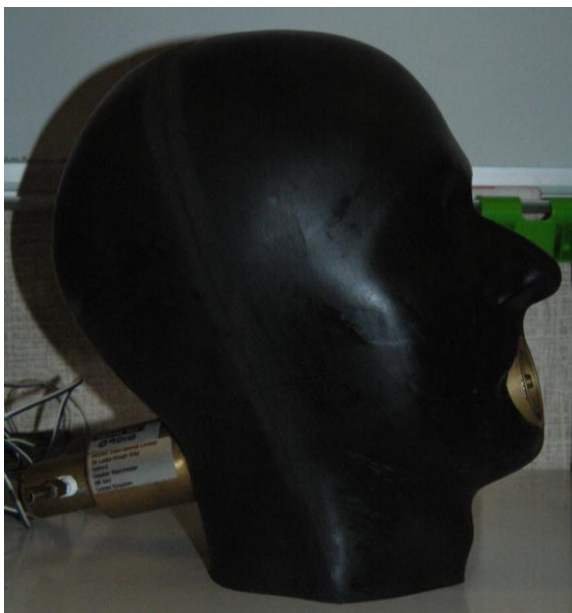
Figure 3-7. Tête Sheffield utilisée et ses dimensions caractéristiques (documentation tirée de la norme EN NF 136, 1998)
