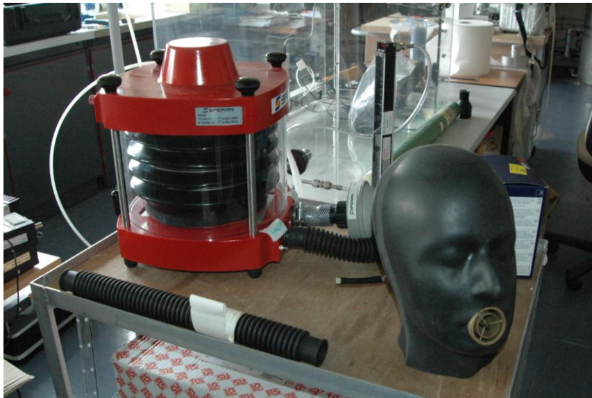
Figure 3-8. Simulateur respiratoire et tête Sheffield utilisés pour la simulation de la respiration du porteur
