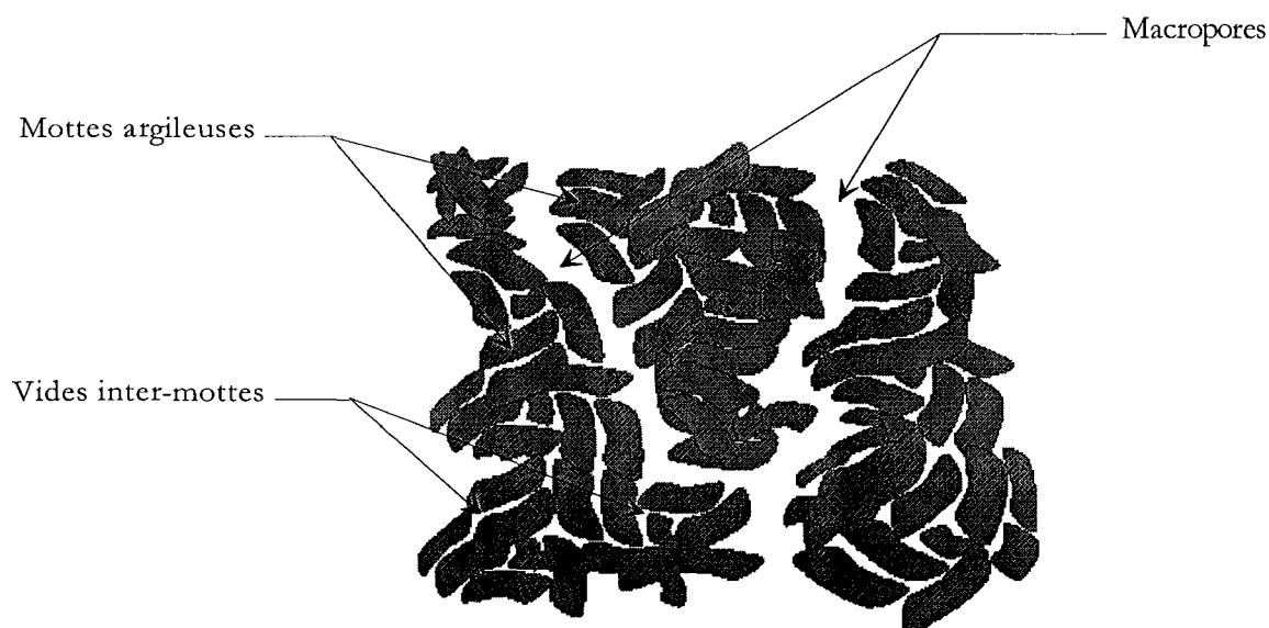
Figure I.4 - Formation des macropores dans les sols fins compactés.
