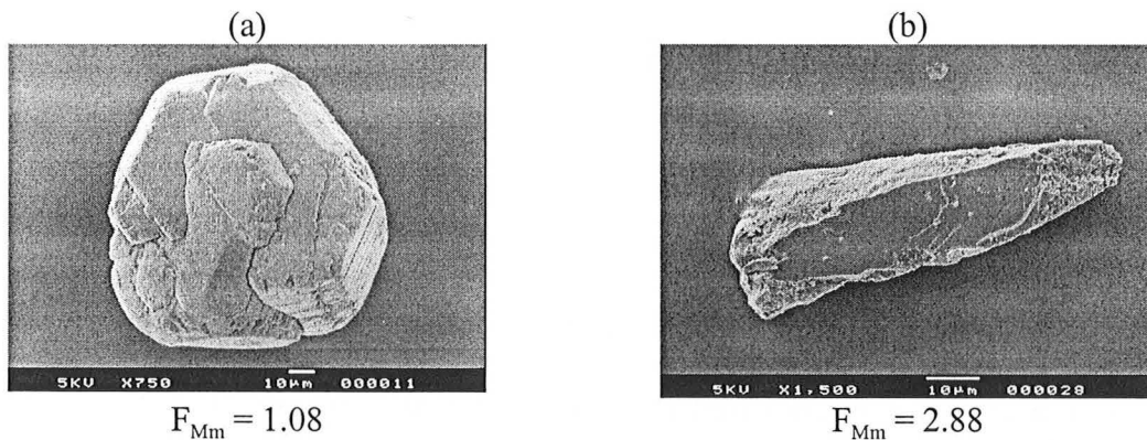
Figure III-7 : (a) une particule d'hydrargillite avant broyage. (b) une particule d'hydrargillite après une minute de broyage.
