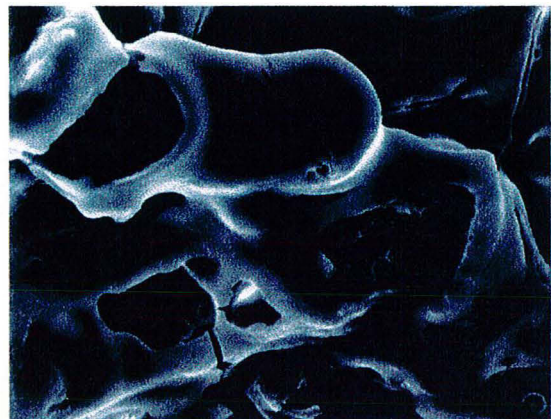
Figure IV.6 Photographie de la surface d'une pastille de cellulose compactée ayant reçu un flux radiatif (grossissement 1000)
