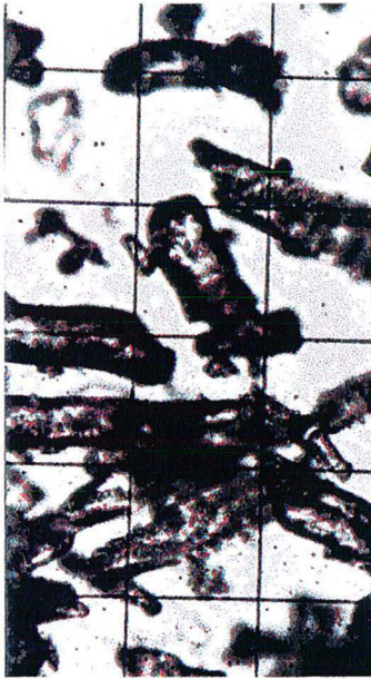
Figure AIV.1 Photographie de particules de cellulose microgranulaire (n°2) (grossissement 40)
