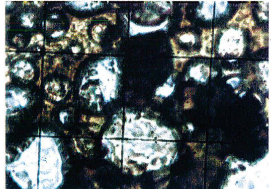
Figure IV.4 Photographie de particules de cellulose ayant reçu un flux radiatif de 0,15 s (grossissement 40)
