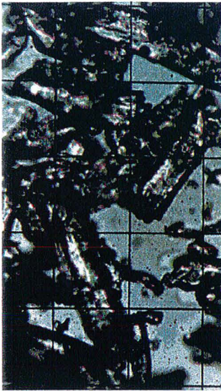
Figure IV.1 Photographie de particules de cellulose microgranulaire (n°1) (grossissement 40)
