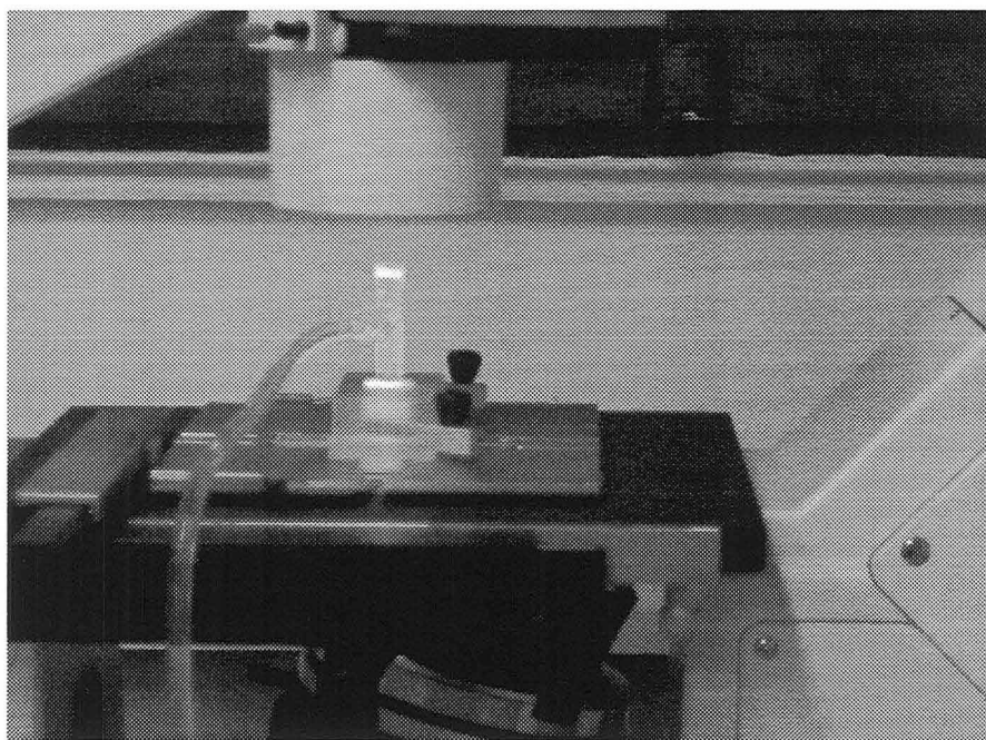
Figure C3 : Détail de la cellule de sédimentation et de la platine.
