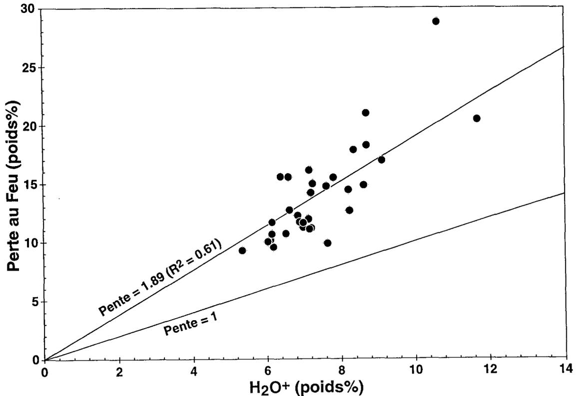
Figure V-5 : Perte au feu en fonction de la teneur en H<sub>2</sub>O<sup>+</sup>. La perte au feu est effectuée sur de matériel préalablement étuvé à 110°C, alors que la teneur en H<sub>2</sub>O<sup>+</sup> est mesurée sur du matériel traité par un plasma froid d'O<sub>2</sub> et déshydraté à 120°C sous vide.
