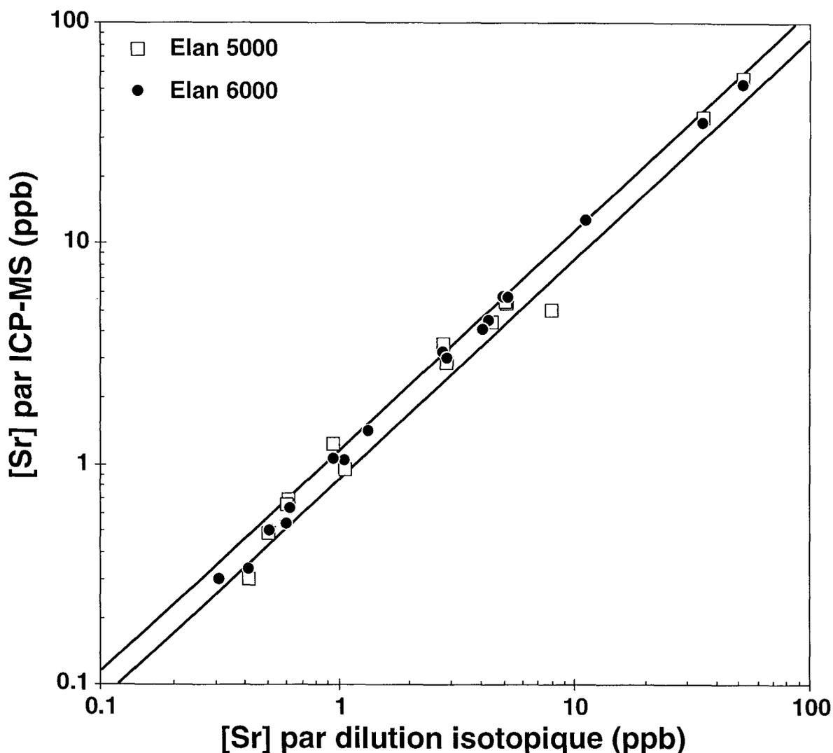
Figure II-8: Comparaison entre les concentrations en Sr des eaux de pluies mesurées par dilution isotopique et ICP-MS. Les deux droites définissent le domaine de  $\pm 10\%$  autour de la droite de pente 1.
