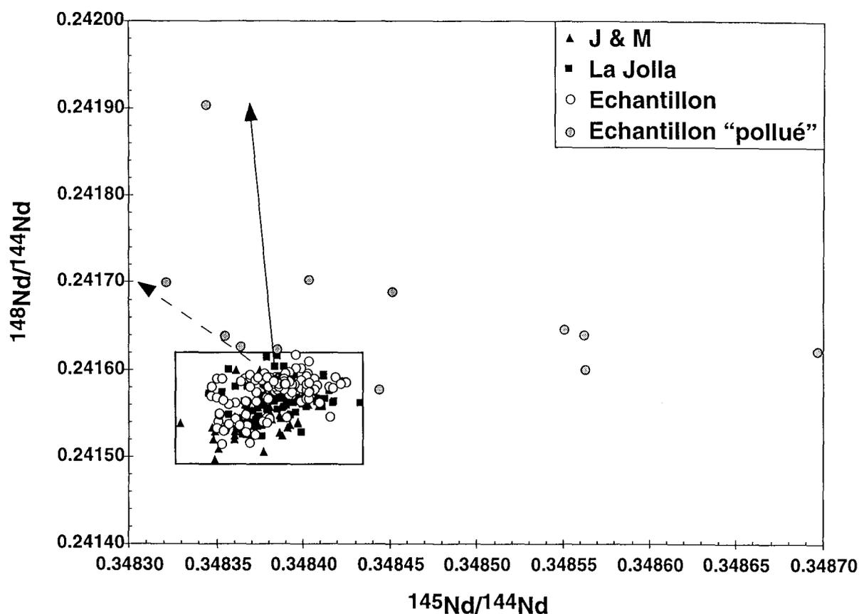
Figure II-16 : Co-variation des rapports  $^{145}\text{Nd}/^{144}\text{Nd}$  et  $^{148}\text{Nd}/^{144}\text{Nd}$  pour les standards et les échantillons. Les mesures notées « polluées » ont été rejetées. Le rectangle correspond à l'ensemble des compositions mesurées des standards. La flèche en pointillé indique une pollution sur la masse 144 et celle en trait plein simule une pollution en Sm.
