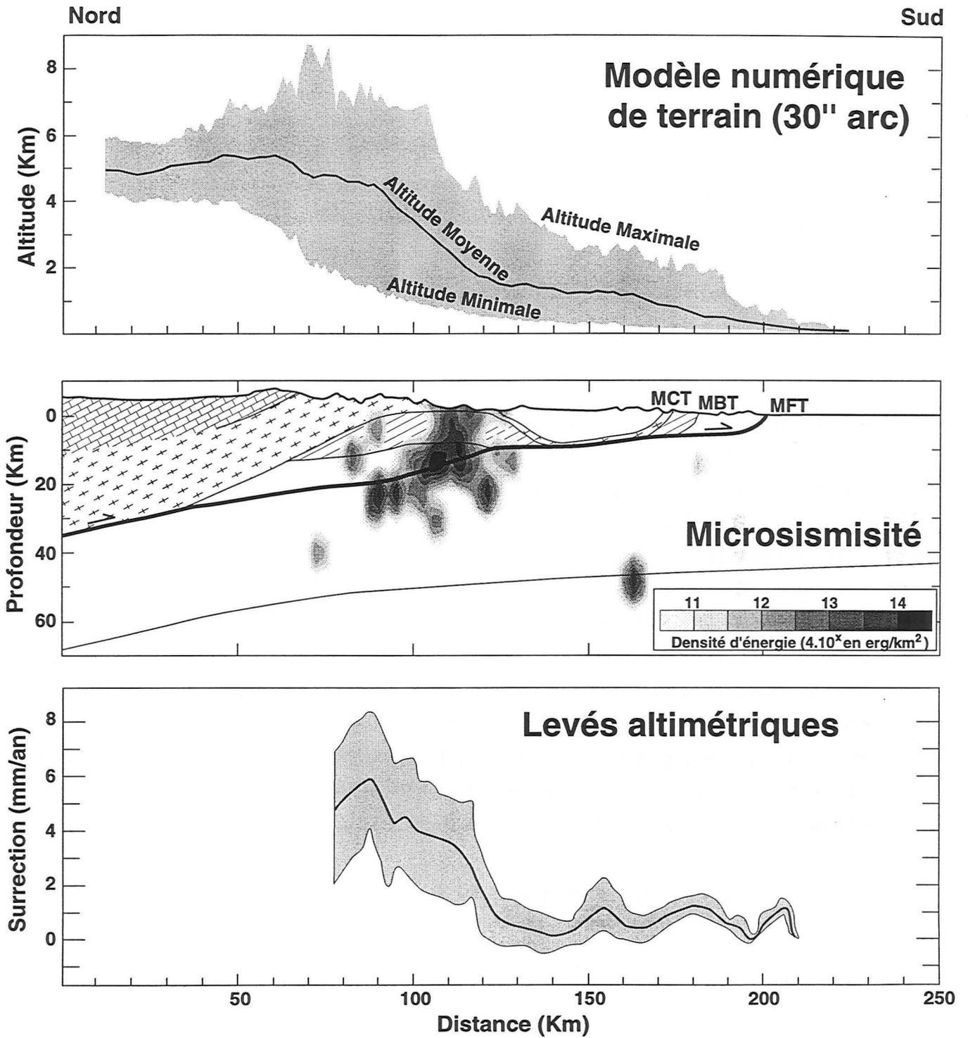
Figure III-4 : (A) Profil topographique le long d'une coupe N-S de la chaîne à l'aplomb de Kathmandou (d'après Lavé, 1997); (B) localisation verticale de la microsismisité sur cette coupe (Lavé, 1997) et (C) surrection verticale actuelle de la chaîne d'après des levés topographiques (Bilham *et al.*, 1997).
