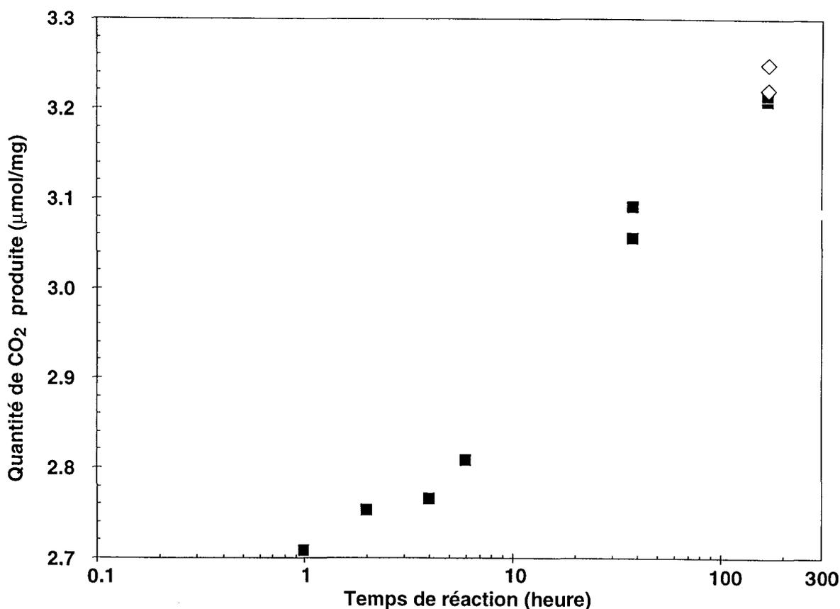
Figure II-21 : Evolution temporelle de la quantité de CO<sub>2</sub> produite par réaction de l'H<sub>3</sub>PO<sub>4</sub> sur des carbonates. Les symboles en noir correspondent à une réaction à 25°C alors que ceux en blanc ont été réalisés à 50°C.
