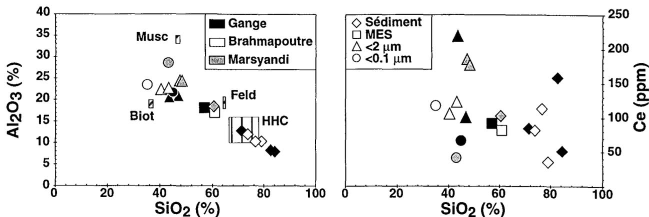
Figure V-11 : Teneur en  $Al_2O_3$  et en Ce en fonction de la teneur en  $SiO_2$ . Pour les différentes fractions granulométriques du Gange, Brahmapoutre et Marsyandi. Le décalage entre les sables et les MES de part et d'autre de la composition de la roche provient du fractionnement minéralogique et permet de calculer la proportion de matériau transporté par la charge de fond.
