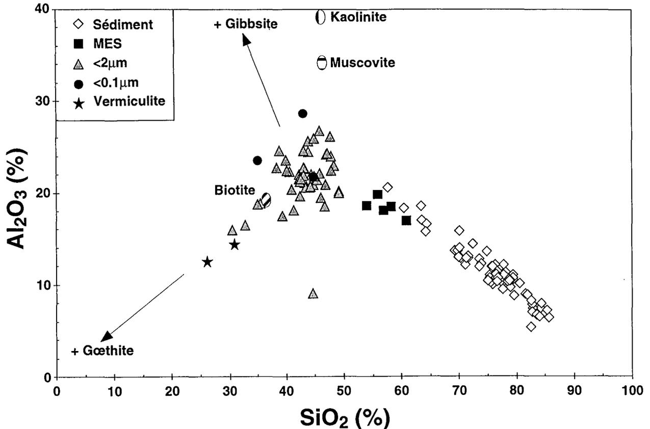
Figure V-8 : Variation de la teneur en  $Al_2O_3$  en fonction de la teneur en  $SiO_2$  pour la fraction silicatée des sédiments, celle des MES et les fractions granulométriques  $<2\mu m$  et  $<0.1\mu m$ . La composition de certains minéraux est rappelée.
