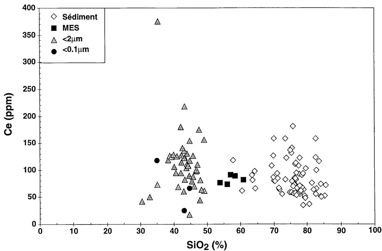
Figure V-10 : Teneur en Ce en fonction de la teneur en  $\text{SiO}_2$ . La teneur en  $\text{SiO}_2$  est celle des silicates, alors que la teneur en Ce est obtenue sur le sédiment total. La variation de la teneur en Ce pour une composition en  $\text{SiO}_2$  donnée est de plus de 100%, ce qui ne peut pas résulter d'un quelconque effet de dilution sur le Ce par les carbonates.
