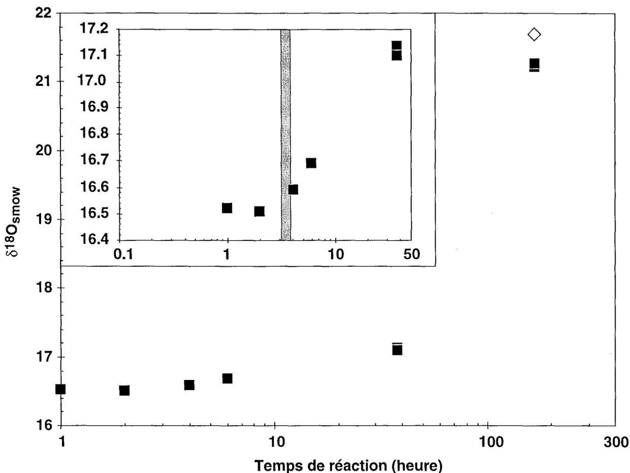
Figure II-22 : Evolution temporelle du  $\delta^{18}\text{O}$  total du carbonate par réaction avec de l' $\text{H}_3\text{PO}_4$ . Les symboles en noir correspondent à une réaction à 25°C alors que ceux en blanc ont été réalisés à 50°C. La bande grisée correspond au temps d'extraction utilisé sur les échantillons.
