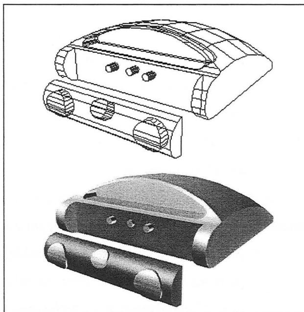
Figure 31 : Extrait du modèle numérique réalisé sous 3D Studio MAX traduisant le préconcept d'autoradio défini lors de la deuxième itération
