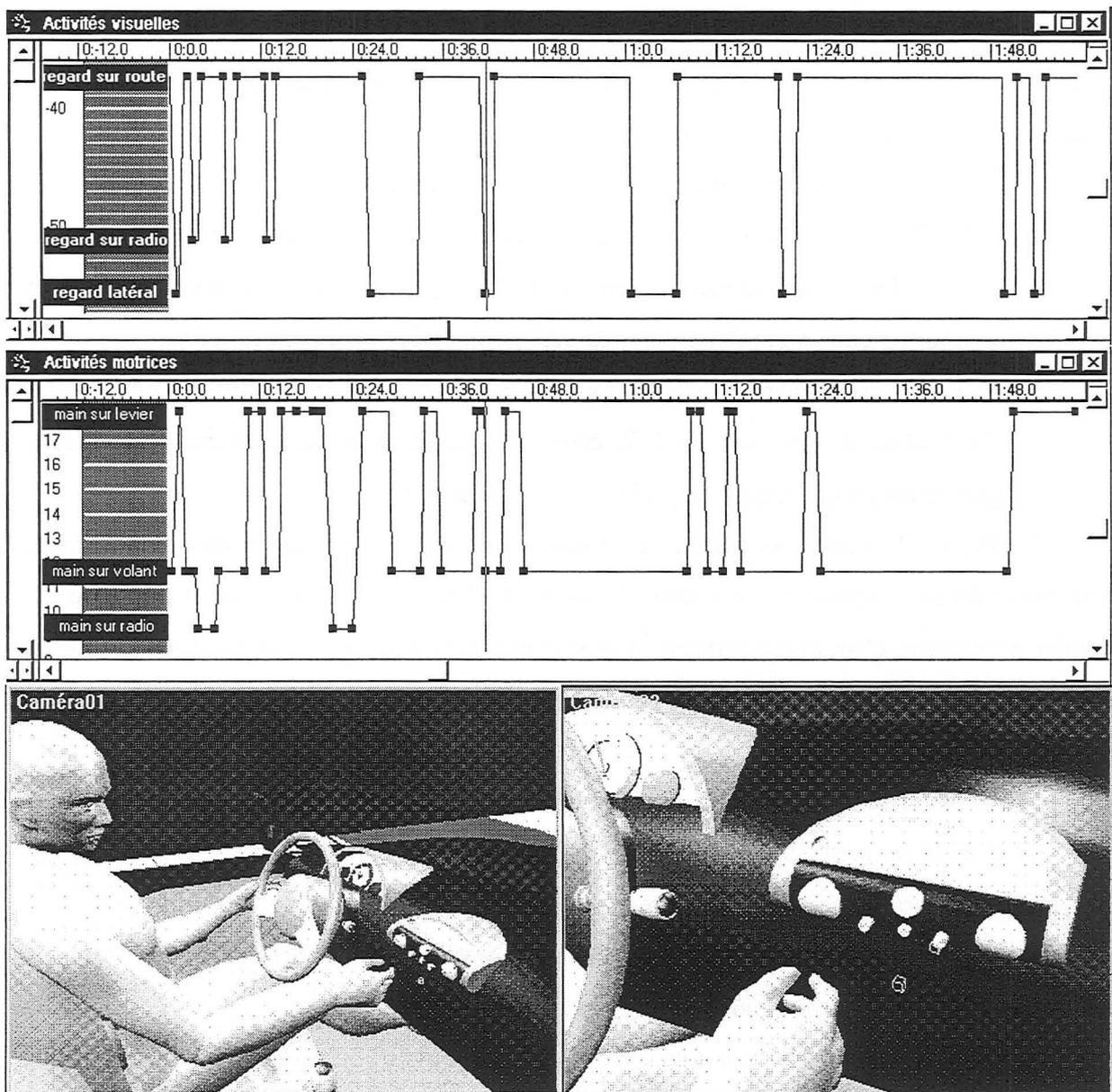
Figure 27 : Simulation virtuelle sous MANERCOS des activités visuelles et motrices d'utilisation du préconcept 1 d'autoradio
