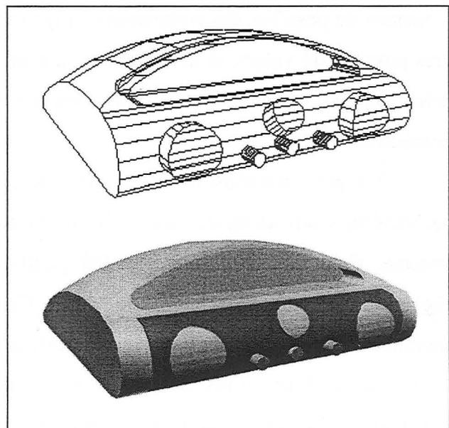
Figure 26 : Extrait du modèle numérique réalisé sous 3D Studio MAX traduisant le préconcept d'autoradio retenu lors de la première itération
