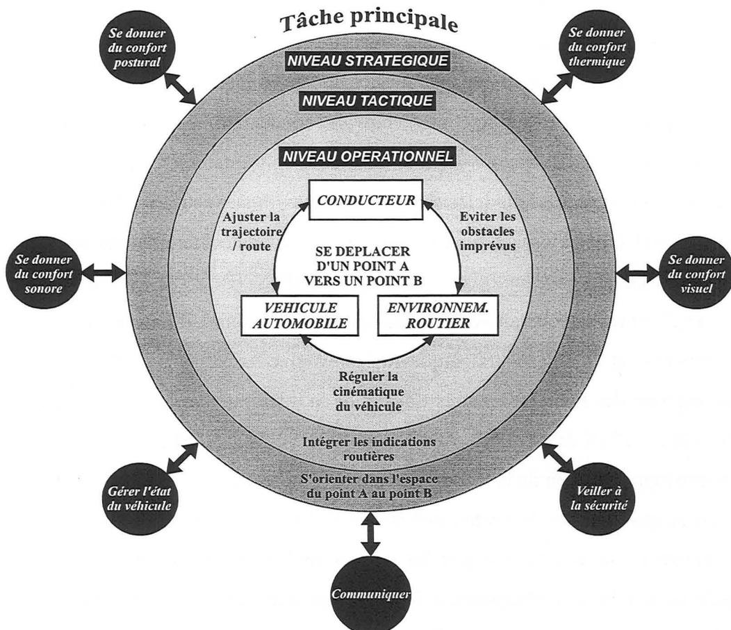
Figure 6 : Représentation des tâches secondaires interférant avec la tâche principale de conduite dans le cadre du système Conduc-teur-Véhicule-Environnement (inspiré de NEBOIT, 1974 ; RASMUSSEN, 1983 ; CHICH, 1987 ; PLECZON, 1992)
