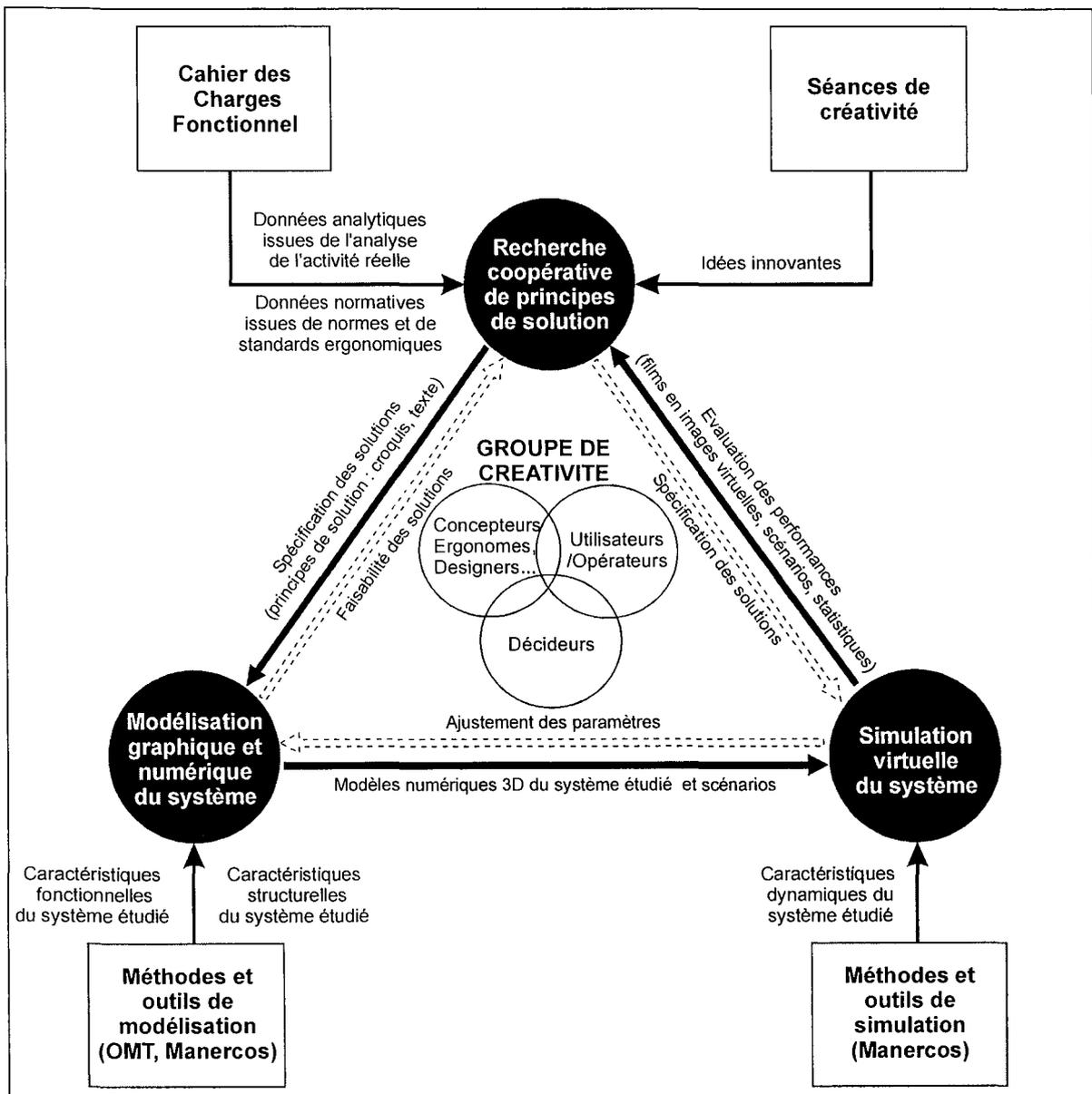
Figure 34 : Démarche de recherche coopérative de solutions basée sur la modélisation graphique et numérique du système et la simulation virtuelle de certaines activités futures souhaitables d'utilisation - Démarche proche des travaux de RAUCENT et al. (1997)
