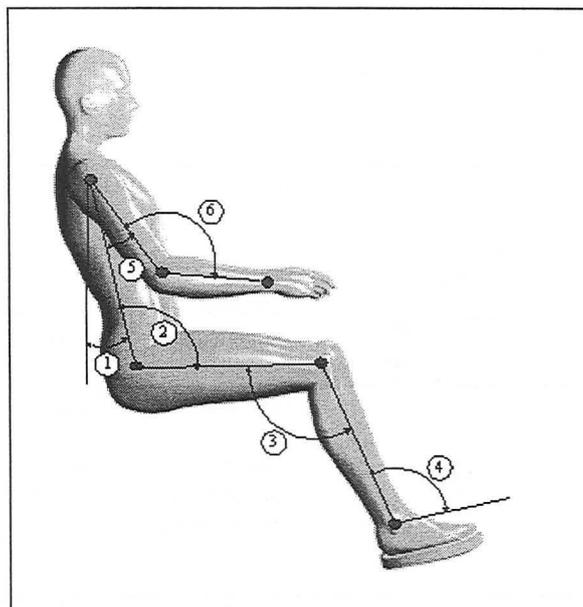
Figure 45 : Localisation des angles de confort entre segments corporels
