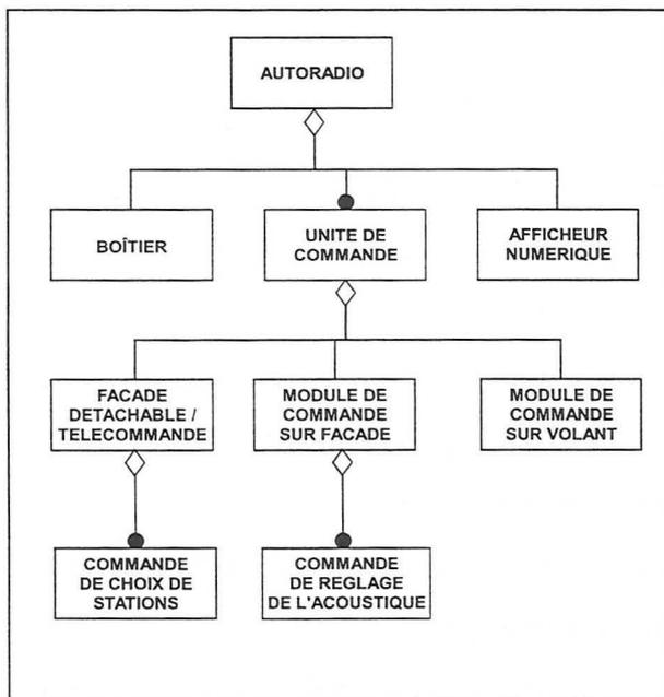
Figure 30 : Extrait du modèle structurel issu de la modélisation graphique sous OMT du deuxième préconcept d'autoradio
