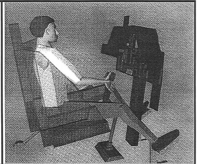
Figure 39 : Analyse par JACK de l'utilisabilité d'un poste de pilotage
