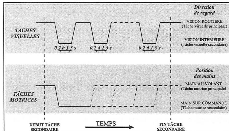
Figure 7 : Modèle d'échantillonnage, au cours de la conduite automobile, des tâches visuelles et motrices (WIERWILLE 1993)
