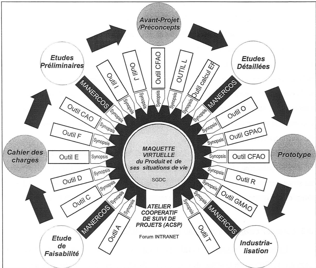
Figure 50 : Architecture des différents outils XAO gravitant autour de l'ACSP et montrant le positionnement du processus de conception préconisé dans la démarche d'ingénierie concurrente
