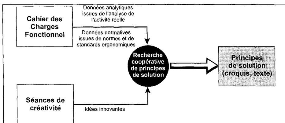
Figure 17 : Données d'entrées et résultats issus de l'étape de recherche coopérative de principes de solution en groupe de créativité sur maquette virtuelle (CETIM, 1997 ; TICHKIEWITCH, 1998)
