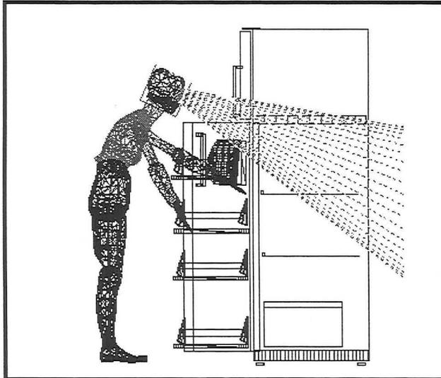
Figure 38 : Analyse de l'atteinte manuelle et visuelle sur MANNEQUIN/MQPRO
