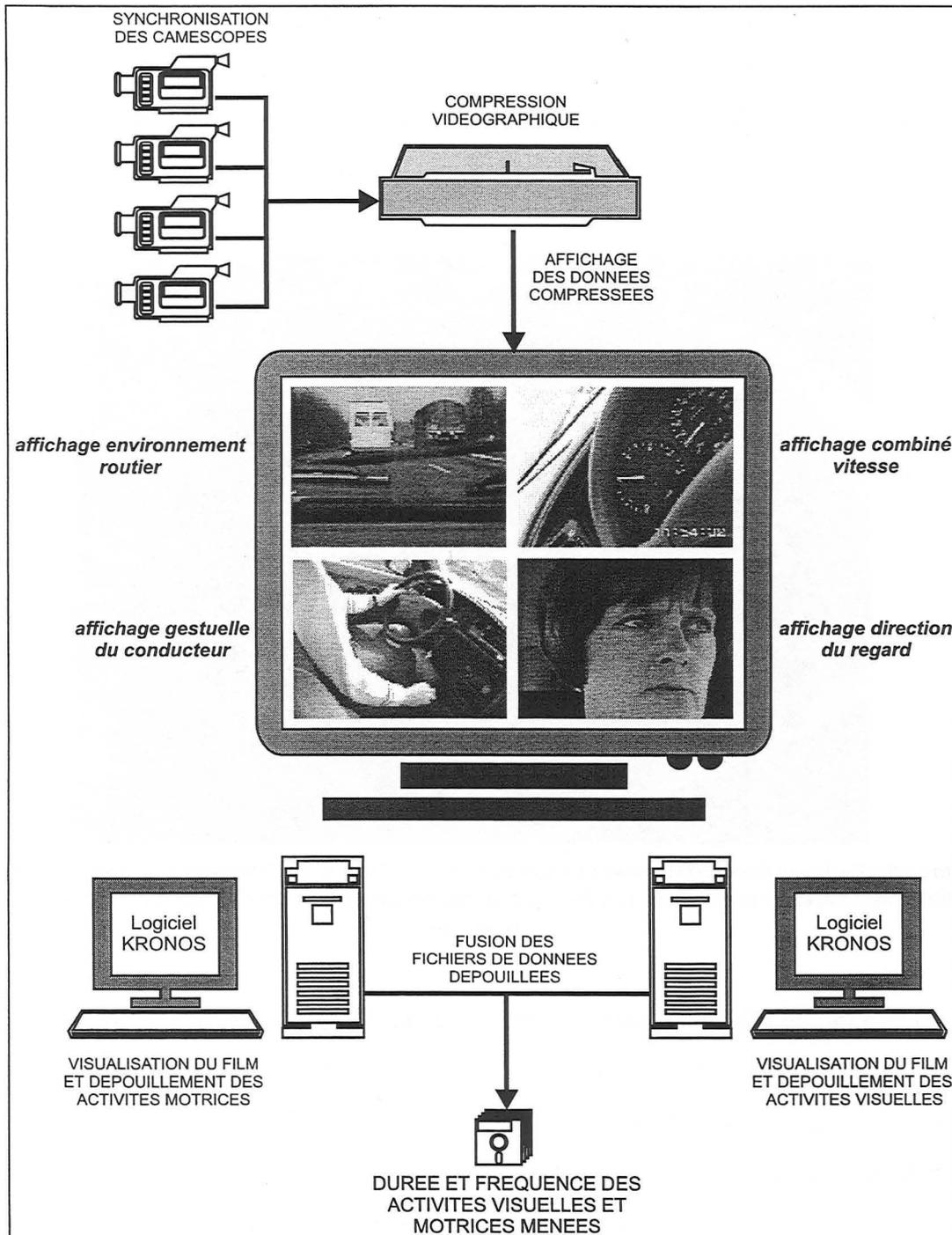
Figure 11 : Banc de dépouillement des données observées, utilisation du logiciel KRONOS
