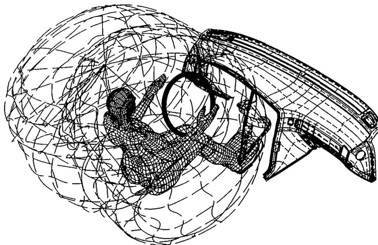
*Figure 35 : Illustration du premier mannequin développé par L'ERCO sur CATIA. Exemple de représentation de la limite d'atteinte digitale du 5ème centile masculin prévisionnel en station assise de confort de conduite automobile (GOMES et SAGOT, 1996)*
