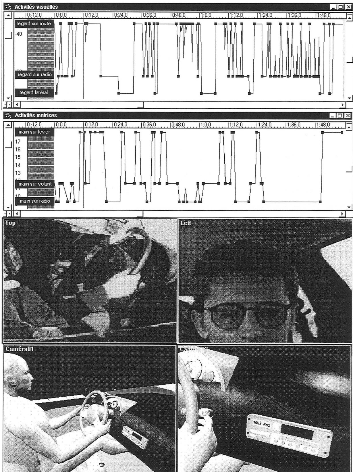
*Figure 23 : Transposition sous MANERCOS des activités réellement observées au modèle numérique du système Conducteur-Autoradio existant-Environnement. Cette étape permet de préparer les étapes suivantes de recherche coopérative de solutions basée sur la simulation virtuelle du futur système et de "certaines activités gestuelles futures souhaitables" d'utilisation associées*
