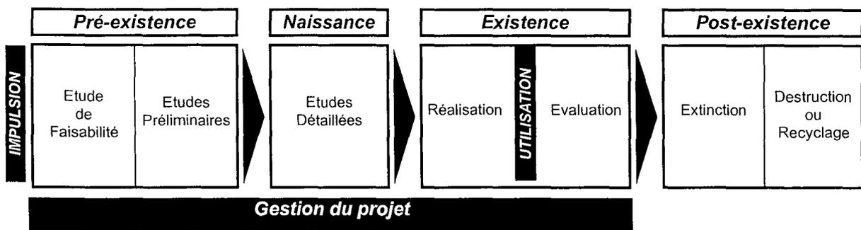
Figure 1 : Illustration simplifiée du cycle de vie global d'un système inspiré des travaux de QUARANTE (1994) et de BOCQUET et al. (1996)
