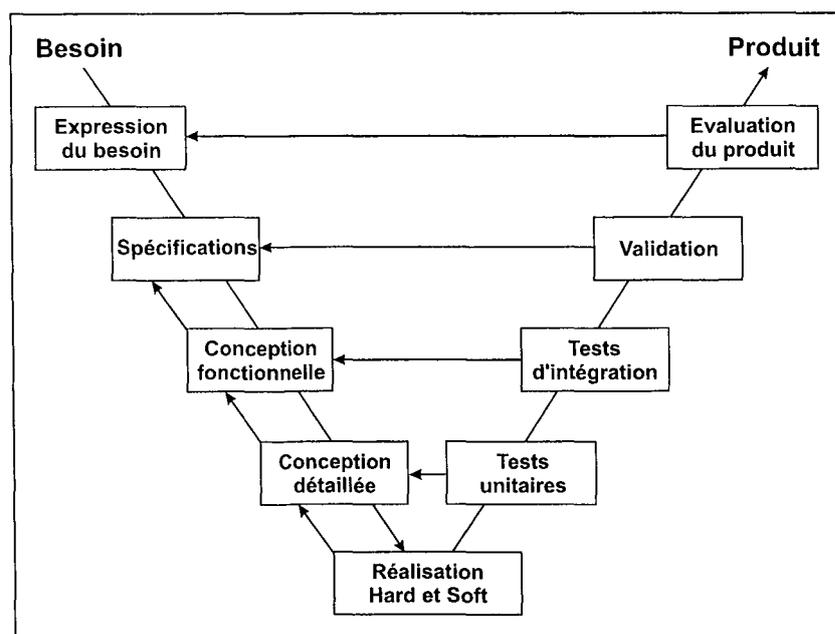
Figure 36 : Le cycle de développement en V utilisé pour la conception de logiciels informatiques (d'après CALVEZ, 1990)
