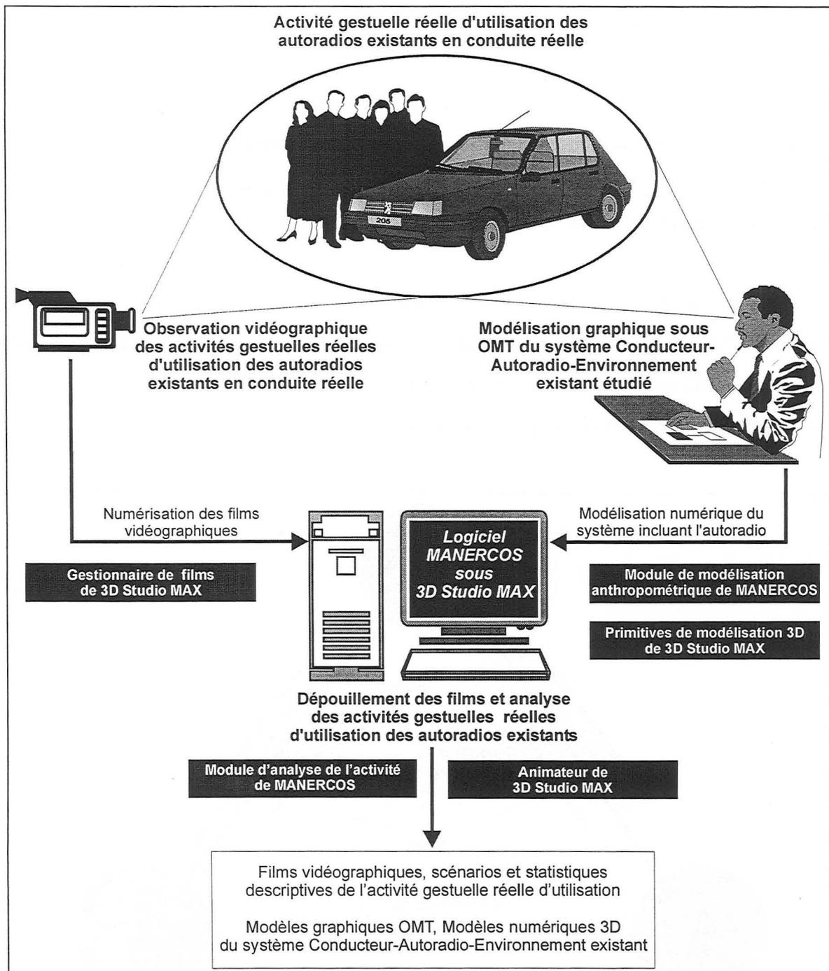
Figure 47 : Description des modalités d'utilisation des différentes fonctionnalités du logiciel MANERCOS couplées à celles de 3D Studio MAX, lors de l'analyse de "l'activité gestuelle" réelle d'utilisation des autoradios existants, en phase d'étude de faisabilité
