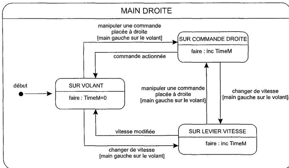
Figure 21 : Statechart traduisant un extrait du modèle dynamique de la "classe d'objet Main Droite"
