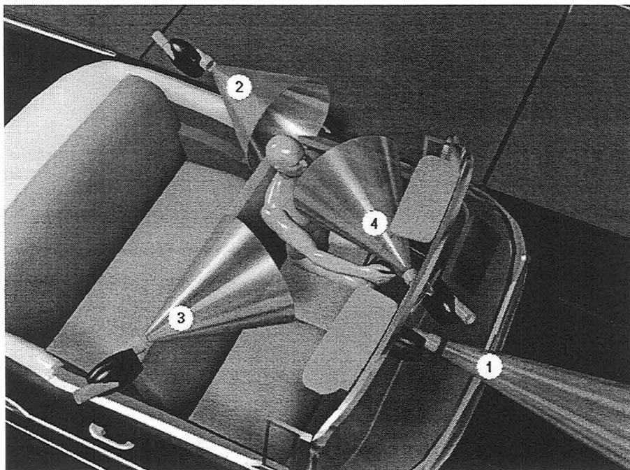
*Figure 10 : Positions des caméras pour l'enregistrement synchronisé de l'environnement extérieur (1), du combiné vitesse et de sa zone proche (2), des activités motrices du conducteur (3) ainsi que des directions de regard (4)*
