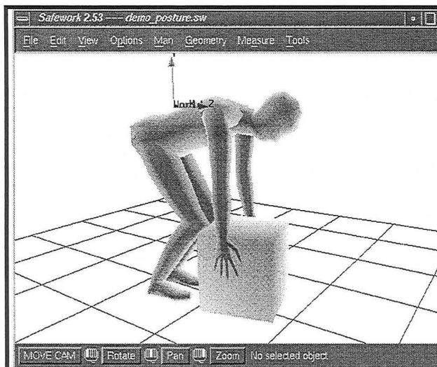
Figure 40 : Analyse posturale par SAFEWORk lors d'une manutention
