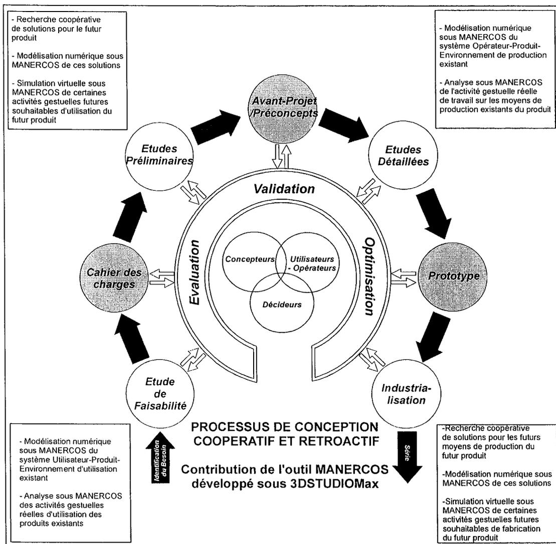
Figure 52 : Positionnement de l'outil MANERCOS dans notre démarche de conception des systèmes Homme-Produit-Environnement basée sur "l'activité gestuelle" d'utilisation, de fabrication, etc., du produit
