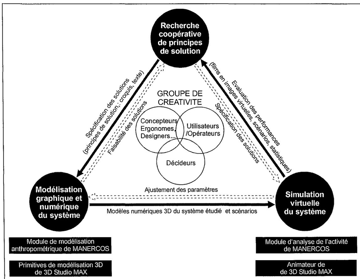
**Figure 48 : Description des modalités d'utilisation des différentes fonctionnalités du logiciel MANERCOS couplées à celles de 3D Studio MAX, lors de la démarche de recherche coopérative de solutions, en phase d'études préliminaires**
