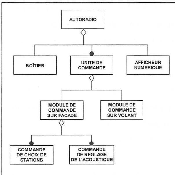
Figure 25 : Extrait du modèle structurel issu de la modélisation graphique sous OMT du premier préconcept d'autoradio
