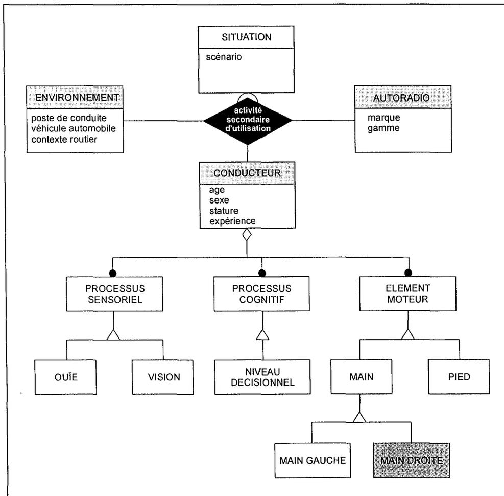
Figure 20 : Extrait du modèle structurel du système Conducteur-Autoradio existant-Environnement présenté avec un très haut niveau d'abstraction et utilisant le formalisme orienté objet OMT
