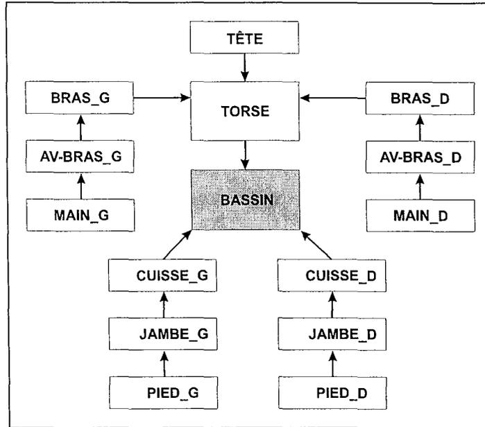
Figure 44 : Architecture et liens hiérarchiques mis en oeuvre pour construire la structure des mannequins, l'objet bassin étant l'objet maître de toute l'arborescence
