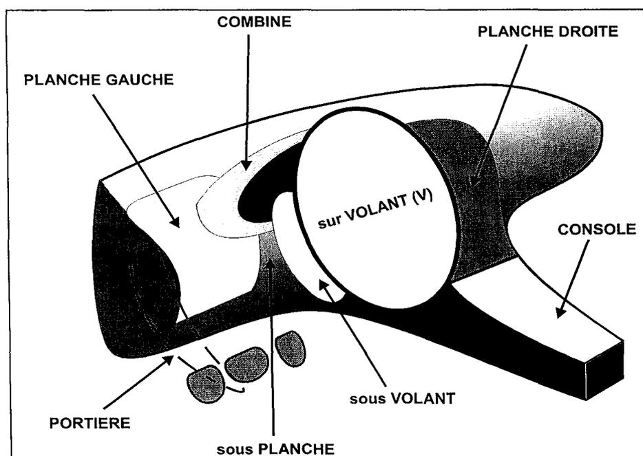
Figure 8 : Zones d'implantation des commandes retenues pour la suite du projet
