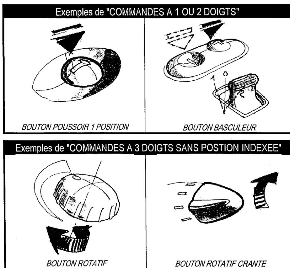
Figure 9 : Extrait de la typologie des commandes considérée pour le projet - Croquis réalisés par H. BAUME
