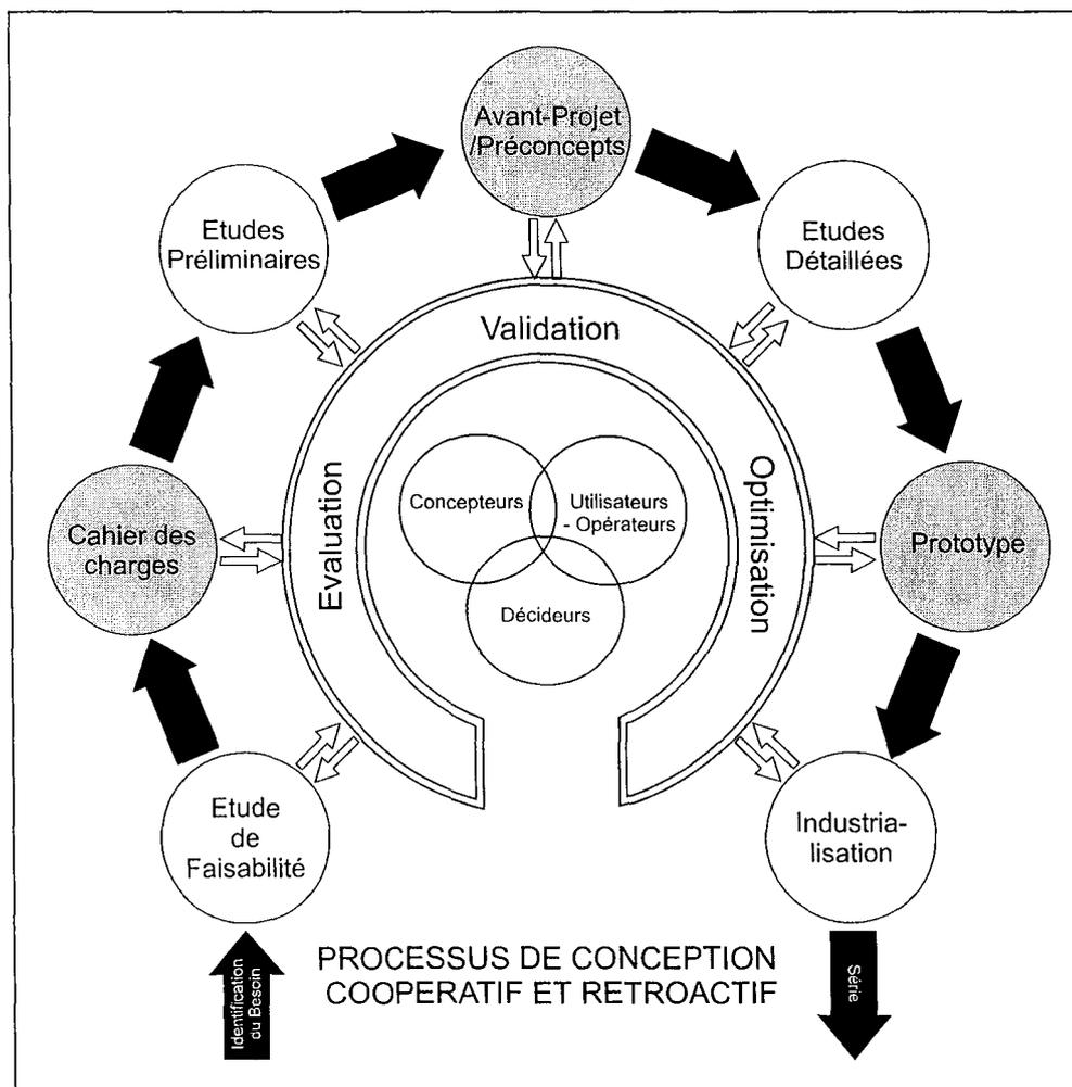
Figure 3 : Démarche de conception préconisée dans le cadre de ce travail - Succession de phases (d'Analyse-Synthèse)/Validation centrée autour de l'ensemble des acteurs de la conception incluant utilisateurs et opérateurs
