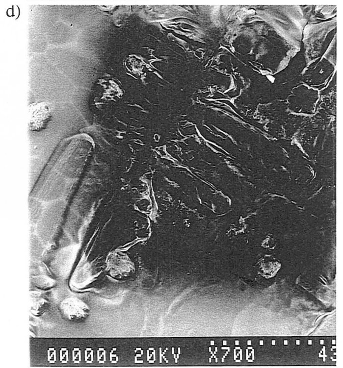
Fig.2.16 : Photographies au MEB du dépôt de l'échantillon MO17 (eau de pluie avec de faibles concentrations en éléments dissous) + ajout de 1 \mu l d'eau de mer sans bore. a) Les cristaux de cet échantillon ont des formes dendritiques et aucun cristal cubique n'est visible. Dans ce cas, le \mu l d'eau de mer sans bore ajouté sert à augmenter la teneur en sodium de l'échantillon afin de pouvoir plus aisément effectuer l'alignement sur la masse du Na (23) qui est un des éléments qui a une bonne émission. b) Le cratère 100x100 \mu m dû à l'impact du faisceau d'oxygène de la sonde est très nettement visible sur l'image en électrons rétrodiffusés. c) et d) Détails des deux photos précédentes.
