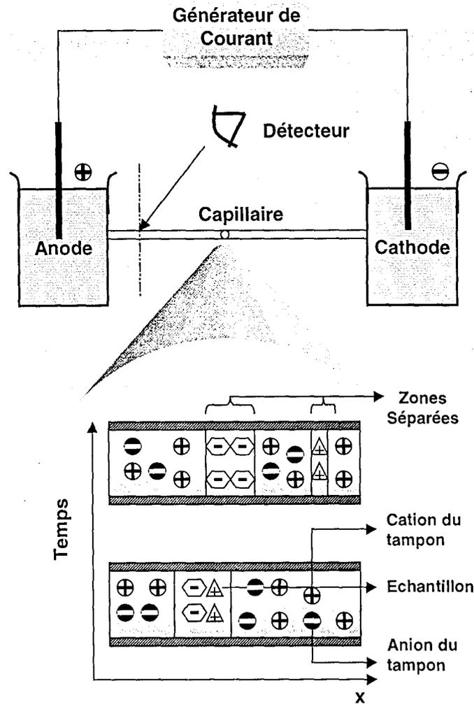
Figure III-1 Représentation de la séparation par l'électrophorèse de zone.
