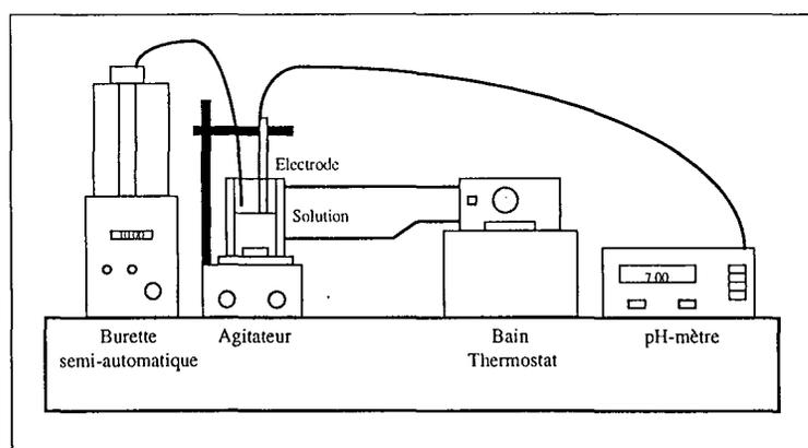
**Figure VI-1** Dispositif expérimental.
