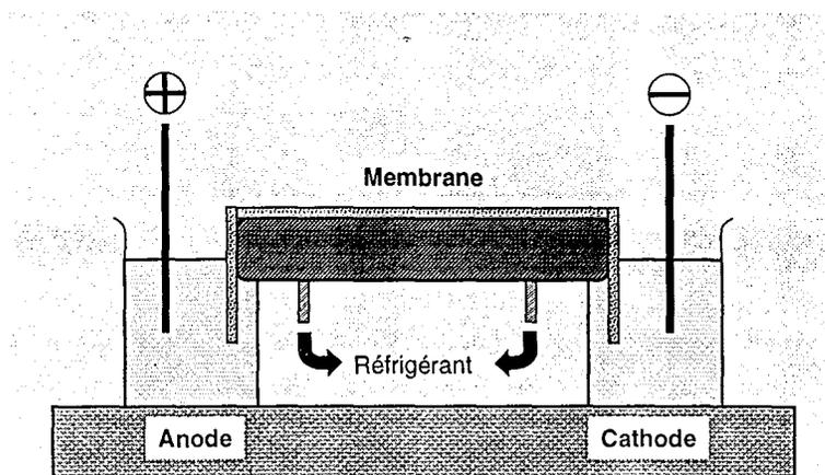
**Figure III-3** Représentation de la séparation par électrophorèse sur membrane en acétate de cellulose.
