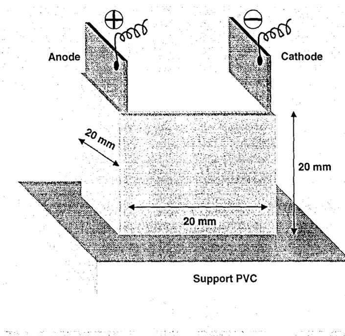
**Figure IV-3** Vue schématique de la cellule conductimétrique utilisée : les supports sont en PVC et les électrodes sont des feuilles de platine.
