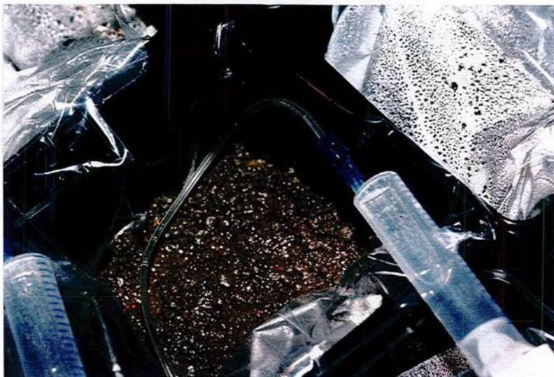
Photographie 3 : Prélèvement de la solution du sol par l'échantillonneur SMS dans terre nue.
