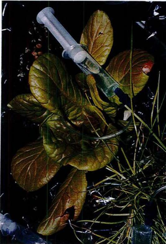
Photographie 2 : Prélèvement de la solution du sol par l'échantillonneur SMS dans un milieu cultivé.
