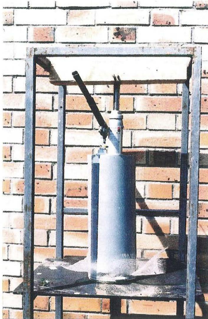
Fig. 2.2. Photo montrant le processus du tassement du sol effectué à l'aide d'un cric hydraulique.
