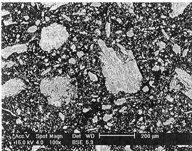
Figure II-13 photo MEB ( électrons rétrodiffusés avec contraste de numéro atomique ) d'un mélange \text{Fe}_{0.50}\text{V}_{0.50} non broyé (Fe en gris clair et V en gris foncé)
