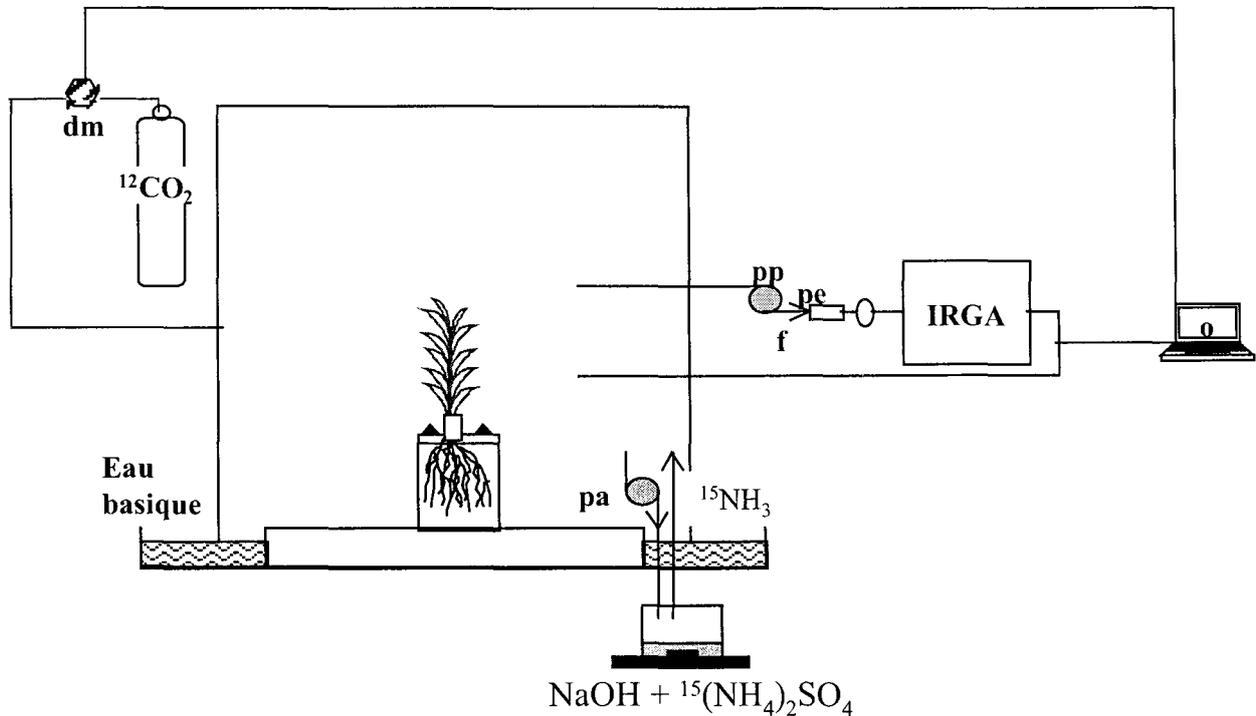
Figure 10 : Dispositif de marquage des plantes au  $^{15}\text{NH}_3$ . Les plantes assimilent le  $^{15}\text{N}$  par leurs parties aériennes. dm : débitmètre massique, o : ordinateur, pp : pompe péristaltique ; pa : pompe aquarium ; pe : piège à eau. L'eau basique permet d'éviter le piégeage du  $^{15}\text{NH}_3$  pendant le marquage.
