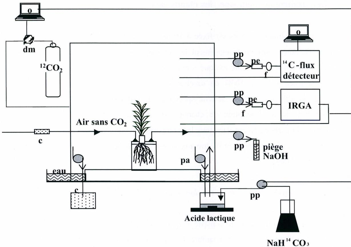
Figure 7: Dispositif de marquage des parties aériennes des plantes au  $^{14}\text{CO}_2$ ,  $^{13}\text{CO}_2$ . c : chaux sodée, dm : débitmètre massique, f : filtre de  $0,2\mu\text{m}$ , o : ordinateur, pp : pompe péristaltique ; pa : pompe aquarium ; pe : piège à eau.
