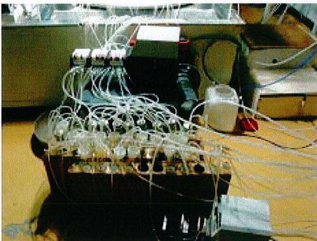
Photographie 1 : Pièges à soude contenant 200ml de  $\text{NaOH}$  1M permettant de mesurer la respiration rhizosphérique. Il y a un piège à soude par pot.
