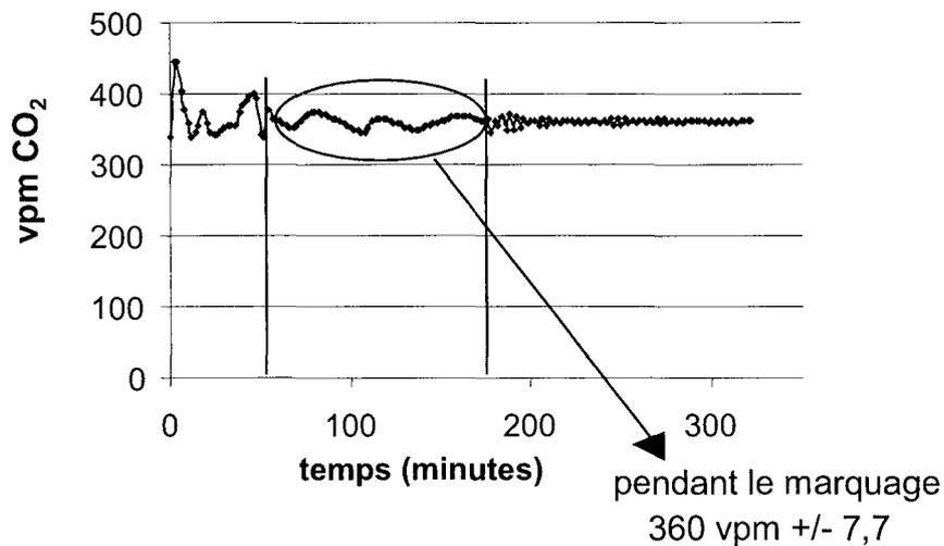
Figure 9 : Evolution de la concentration en  $\text{CO}_2$  dans l'enceinte de marquage, avant, pendant le marquage et après le marquage. Grâce au système informatique, la concentration en  $\text{CO}_2$  dans l'enceinte de marquage reste constante tout au long de l'expérience.
