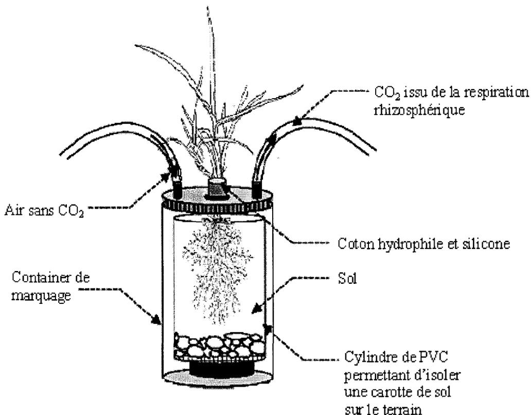
Figure 19 : Container de marquage renfermant un cylindre de PVC planté d'un ray grass destiné à être marqué au <sup>14</sup>CO<sub>2</sub>. Le couvercle présente une ouverture permettant le passage de la plante. Cette ouverture, une fois la plante mise en place est bouchée avec du silicone liquide. Le couvercle présente également 2 trous permettant le branchement de 2 tuyaux reliés aux pièges à soude utilisés pour piéger le CO<sub>2</sub> issu de la respiration rhizosphérique.
