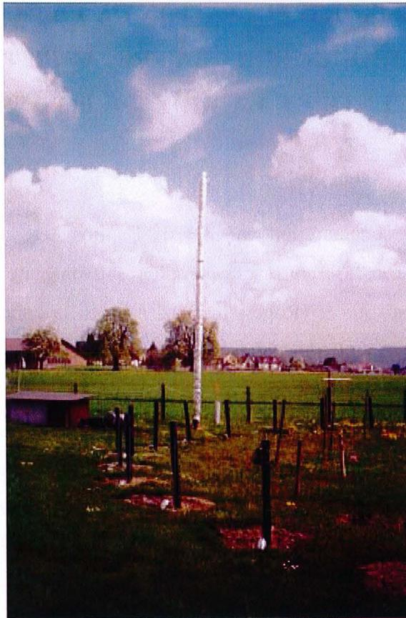
Photographies 5 et 6 : Vue d'un anneau enrichi du dispositif FACE Suisse. On peut distinguer la présence de buse permettant la diffusion du CO<sub>2</sub> au-dessus de la parcelle ainsi que la présence de capteurs de la concentration en CO<sub>2</sub>, de la vitesse du vent et de la température.
