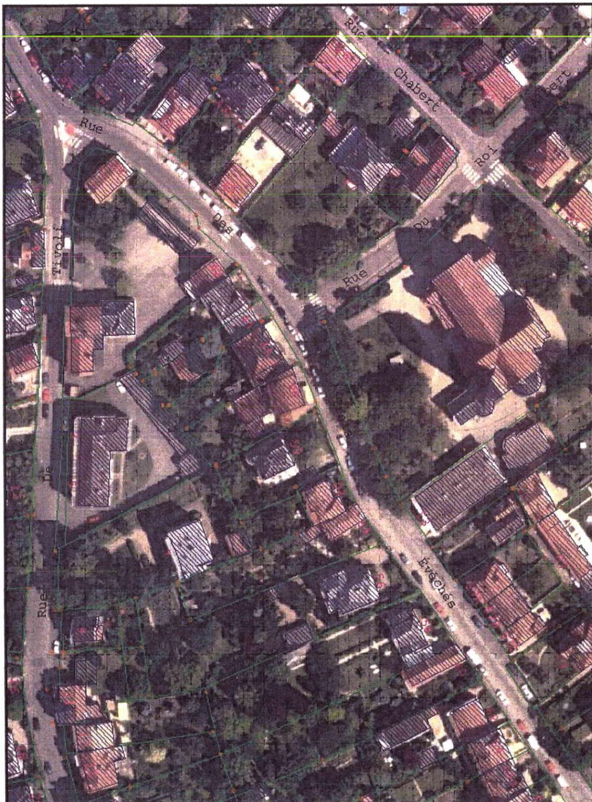
*Fig. N°11: Superposition d'un orthophotoplan et du cadastre digitalisé. (Doc. Ville de METZ)*
