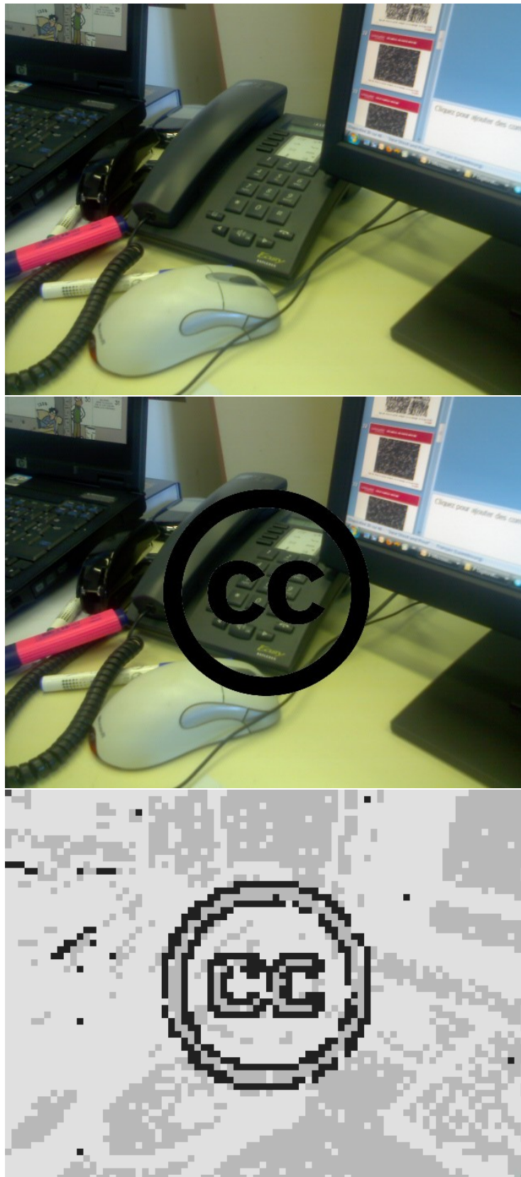
Figure 2.23 – Contrôle de l'intégrité (de gauche à droite) : image certifiée, image modifiée, test de l'intégrité.
