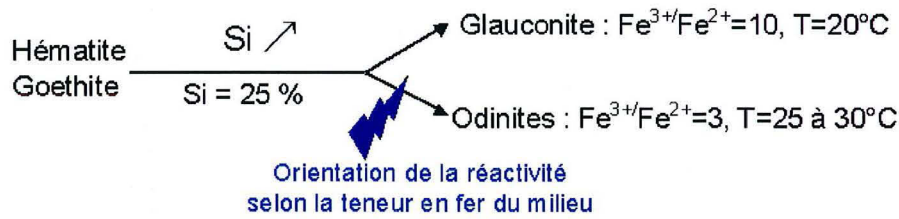
Figure 10 : Evolution des oxydes de fer en condition oxydante en fonction de la teneur en Si et Fe, d'après [Fernandez, 1998 #21 et (Porrenga, D. H. 1967)
