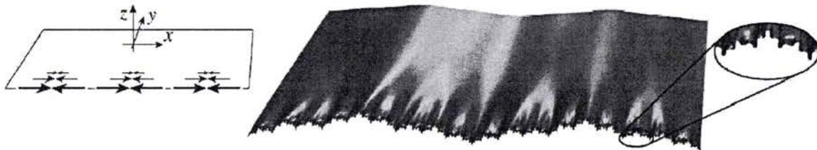
Fig. 3.14 : Flambage d'une plaque dû à un allongement résiduel près d'un bord : \epsilon_{xx}=1/(1+y/l) , simulation numérique : épaisseur 2.9 \cdot 10^{-3} , largeur 1, l=0.08 (d'après Audoly et Boudaoud (2003)).
