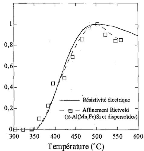
Figure IV. 26 : Courbes cinétiques de résistivité électrique et de fraction volumique de phase  $\alpha$ -Al(Mn,Fe)Si et de dispersoïdes au cours d'un chauffage continu à 50°C/h depuis l'état non déformé.
