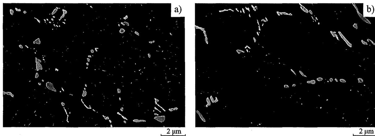
Figure IV.8 : Cliché MEB en mode rétrodiffusé montrant la microstructure des particules primaires après chauffage interrompu à  $600^\circ C$  ( $50^\circ C/h$ ) depuis : a) l'état brut de coulée initial ; b) l'état brut de coulée prédéformé à 15 %.
