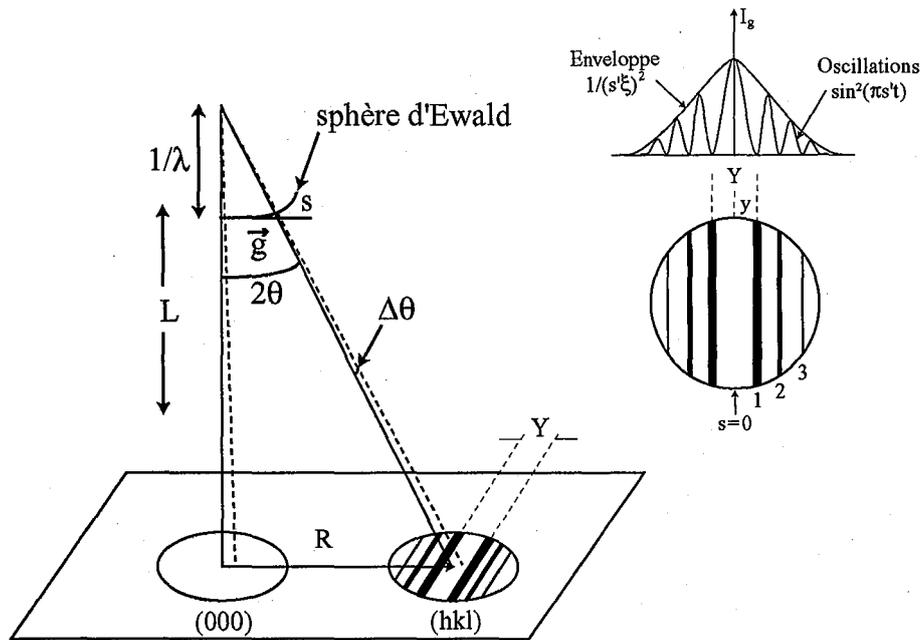
Figure A.4 : Représentation schématique des disques de diffraction en faisceau convergent et des franges d'égal inclinaison.
