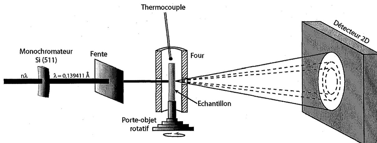
Figure II.3 : Dispositif expérimental utilisé à l'ESRF, Grenoble.
