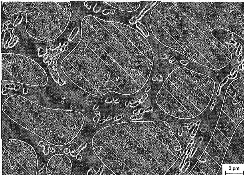
Figure III.28 : Cliché MEB illustrant l'importance des PFZ (surface non hachurée) et la zone analysée sur le MET (surface hachurée) : 1 heure de maintien à 500°C (chauffage à 20°C/s).
