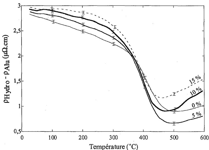
Figure IV.5 : Evolution de la résistivité électrique différentielle (chauffage à  $50^{\circ}C/h$ ) à partir de différents taux de déformation appliqués à l'état brut de coulée.
