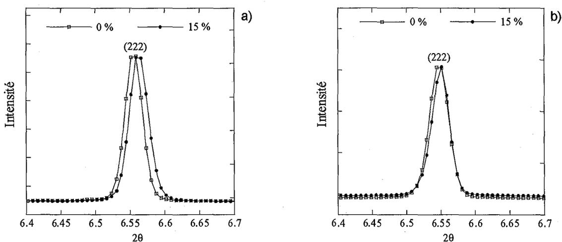
Figure IV.21 : Influence de la déformation sur la position angulaire du pic (222) de la matrice à température ambiante:
