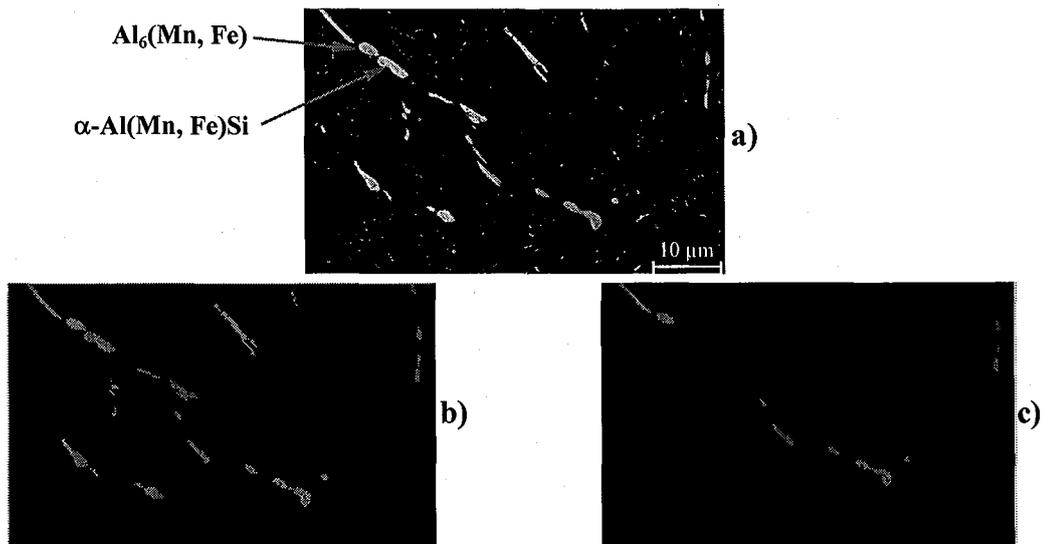
Figure II.4: Illustration de l'identification automatique des phases  $Al_6(Mn, Fe)$  et  $\alpha-Al(Mn, Fe)Si$  : a) image originale en électrons rétrodiffusés ; b) seuillage de  $Al_6(Mn, Fe)$  et  $\alpha-Al(Mn, Fe)Si$  ; c) seuillage de  $Al_6(Mn, Fe)$ .
