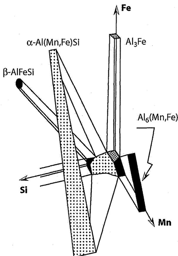
Figure I.2: Représentation schématique du diagramme d'équilibre AlMnFeSi [I.17].
