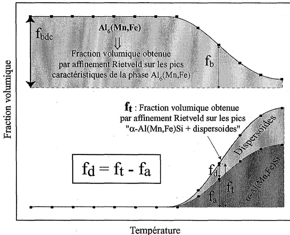
Figure IV.17 : Illustration de la méthode pour déterminer la fraction volumique des dispersoïdes à partir des données expérimentales obtenues par affinement Rietveld sur les pics caractéristiques  $\alpha$ -Al(Mn,Fe)Si + dispersoïdes.
