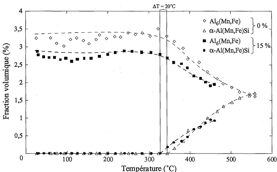
Figure IV.13 : Evolution de la fraction volumique de phase  $\alpha$ -Al(Mn,Fe)Si et de phase  $\text{Al}_6(\text{Mn,Fe})$  au chauffage depuis l'état brut de coulée initial et prédéformé à 15 %.
