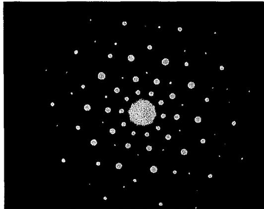
Figure I.6 : Cliché de diffraction des électrons identifiant la phase quasicristalline  $Al_{12}Mn$  dans les tous premiers instants du recuit à  $400^{\circ}C$  [I.37].
