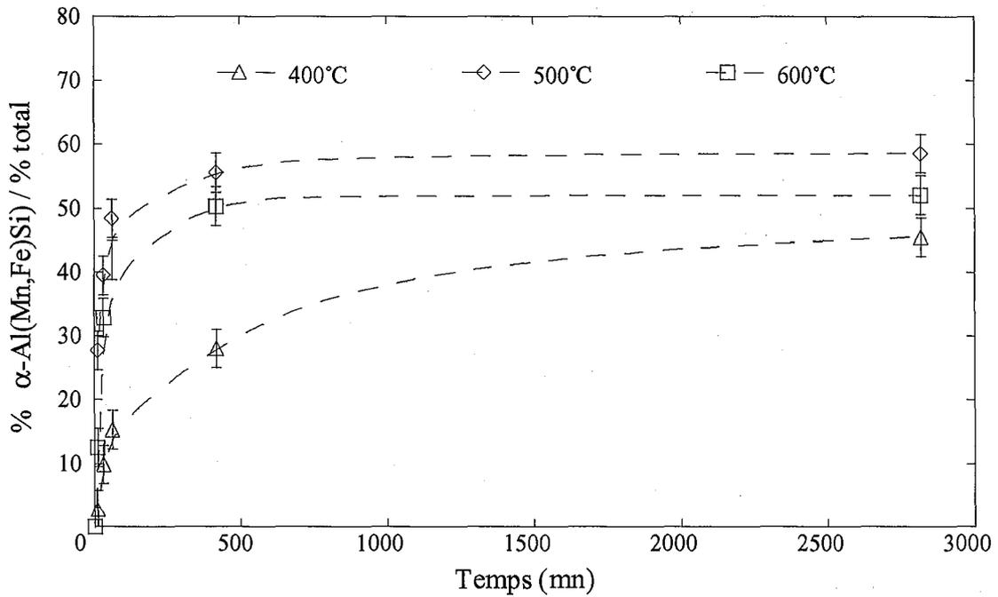
Figure III.20 : Evolution de la fraction surfacique de particules  $\alpha$ -Al(Mn,Fe)Si relative à la fraction totale de particules primaires au cours des maintiens isothermes à différentes températures.
