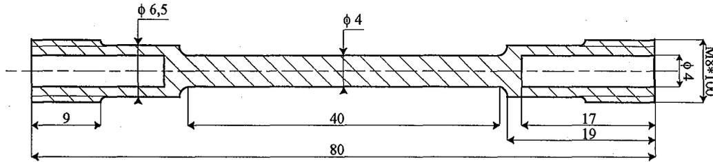
Figure IV.1 : Schéma de l'éprouvette de traction.
