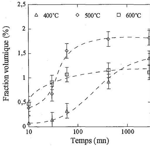
Figure III.32 : Evolution de la fraction volumique globale de dispersoïdes sphériques au cours des maintiens isothermes à différentes températures.
