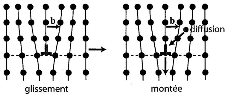
Figure I.9 : Modes de propagation des dislocations.
