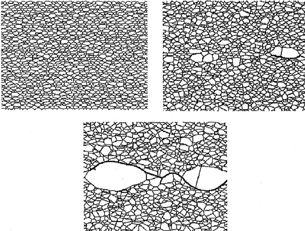
Figure I.14 : Représentation schématique des séquences de croissance anormale au cours d'un traitement de recristallisation [I.52].
