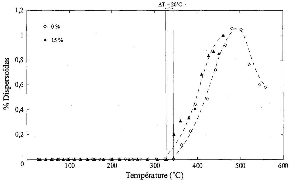
Figure IV.19 : Evolution de la fraction volumique de dispersoïdes au chauffage depuis l'état brut de coulée initial et prédéformé à 15 %.
