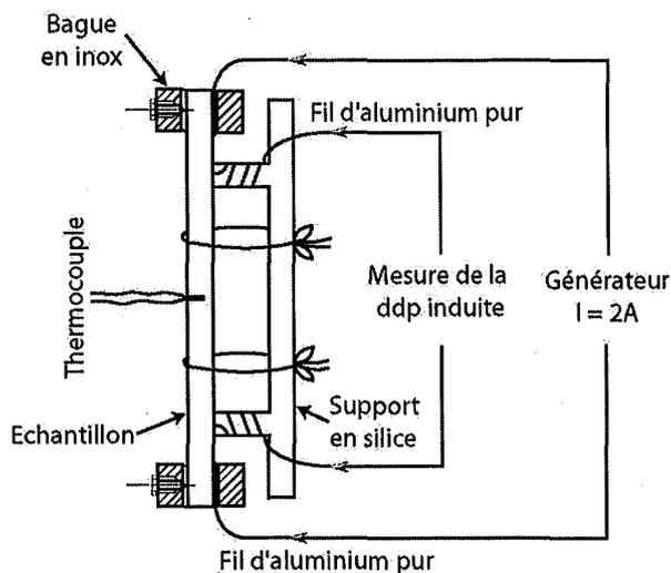
Figure II.1: Dispositif expérimental de résistivimétrie in situ.
