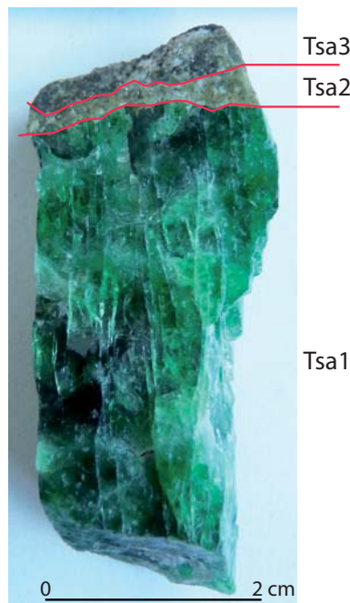
Figure II-36 : Tsavorite d'un nodule provenant de l'indice de Menipa (photo : J. Feneyrol) Du cœur vers la périphérie, trois zones à tsavorite (tsa) sont identifiées : tsa1, au cœur du nodule, massive et gemme; tsa2, une auréole de 1 à 10 mm d'épaisseur formée par une association symplectique de grenat, de zoïsite, de plagioclase, de quartz et de titanite; tsa3 sur la bordure en association avec la scapolite, le diopside et la titanite.
