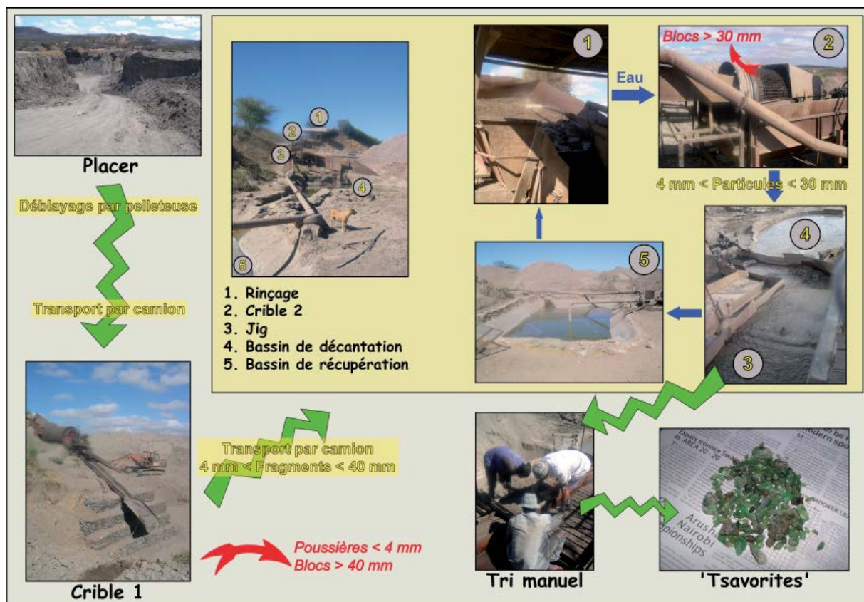
Figure IV-26 : 'Flow-sheet' (mode opératoire) de l'exploitation du placer à 'tsavorite' de Lemshuku
