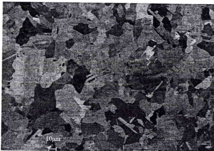
Fig. 3. 3-1 : Microstructure du cuivre I.
