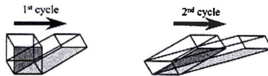
Fig. 1. 1-6 : Déformation pour la route A (Gholinia et al. [2000]).
