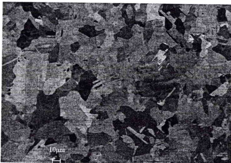
Fig. 3. 3-1 : Microstructure du cuivre I.
