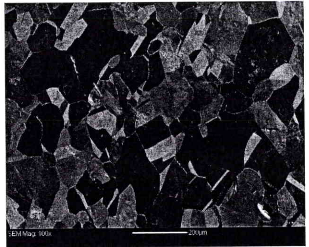
Fig. 3. 3-2 : Microstructure du cuivre II.
