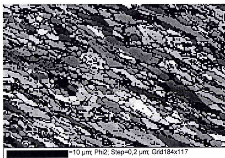
Fig. 4. 3-13 : Microstructure de l'aluminium pour la cinquième passe suivant la route A.
