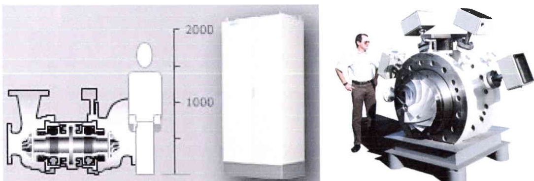
figure 0.3 : Turboexpandeur utilisé sur une plate-forme offshore a) vue en coupe b) fabrication unitaire à S2M [0.43]
