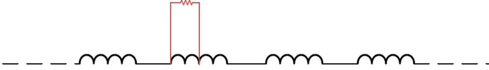
Fig. II-7: Cas de quelques spires en défaut d'une même bobine
