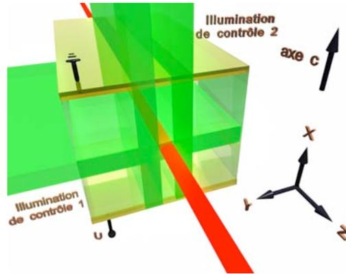
FIGURE B.4 – Schématisation de la configuration expérimentale au niveau du cristal de SBN pour la réalisation d'un guide canal par illumination latérale [7].
