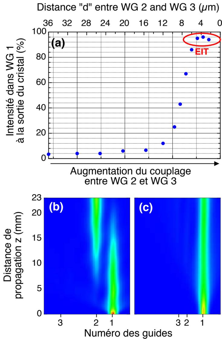
FIGURE 5.10 – (a) L'intensité présente dans les premier guide à la sortie du cristal obtenue par simulations BPM est tracée pour différentes valeurs de  $d$ . Simulations BPM de l'évolution de la lumière au cours de la propagation pour (b)  $d = 36 \mu\text{m}$  et (c)  $d = 2.4 \mu\text{m}$ . Les paramètres utilisés pour les simulations sont identiques à ceux expérimentaux.
