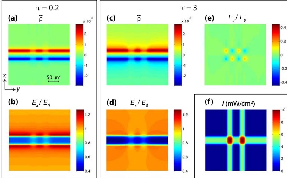
FIGURE B.6 – Dynamique d'établissement de l'effet photoréfractif pour une illumination latérale 2D. Les mêmes grandeurs que celle de la Figure B.1 sont représentées et aux mêmes instants. Excepté l'ajout de deux bandes lumineuses suivant  $x$  dans l'illumination représentée en (f) tous les autres paramètres sont identiques à ceux de la Figure B.1.
