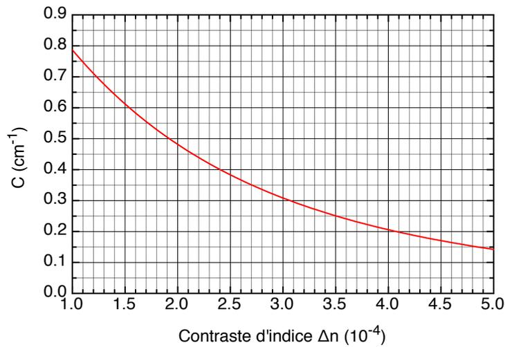
FIGURE 1.9 – Dépendance de la constante de couplage  $C$  avec le contraste d'indice  $\Delta n$ . La longueur d'onde  $\lambda$  est de  $633 \text{ nm}$ , la largeur des guides  $W$  est de  $13 \mu\text{m}$  et la distance inter-guide  $s$  vaut  $7 \mu\text{m}$ .
