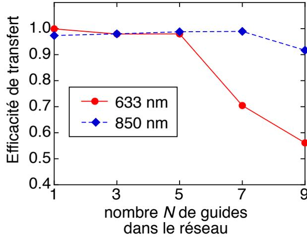
FIGURE 4.11 – Ratio théorique d'intensité  $I_O(z = L)/I_I(z = 0)$  correspondant à l'efficacité de transfert tel que décrit dans l'éq. (4.45) et représenté en fonction du nombre  $N$  de guides dans le réseau pour deux longueurs d'onde différentes (633 et 850 nm). Les paramètres sont ceux du tableau 4.2.
