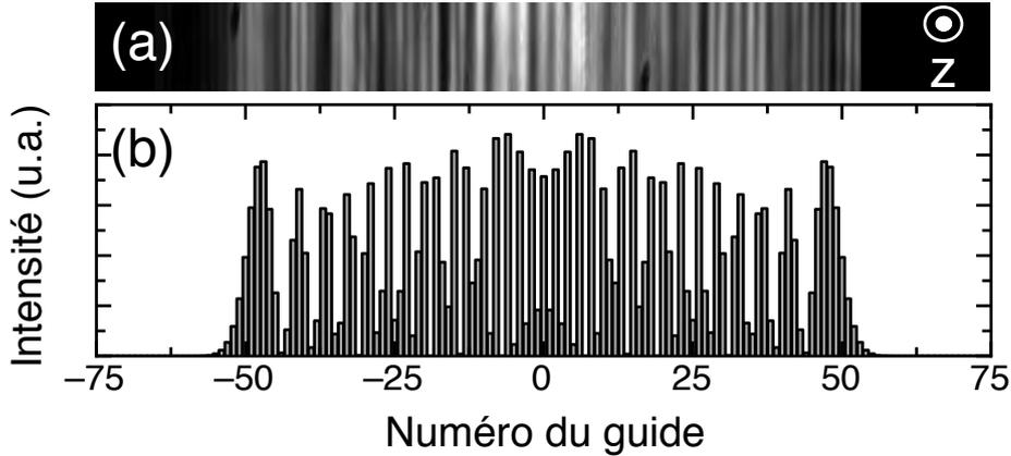
FIGURE 4.14 – (a) : Distribution d’intensité obtenue expérimentalement avec un faisceau sonde à 633 nm pour un réseau comportant 151 guides de période  $\Lambda = 9.6 \mu\text{m}$  est inscrit. Par comparaison de l’amplitude de la diffraction (nombre de guides) avec (b) celle obtenue par calculs CMT pour les mêmes paramètres ( $\Lambda = 9.6 \mu\text{m}$  et  $\Delta n \approx 10^{-4}$ ), on obtient une valeur fidèle de la constante de couplage.
