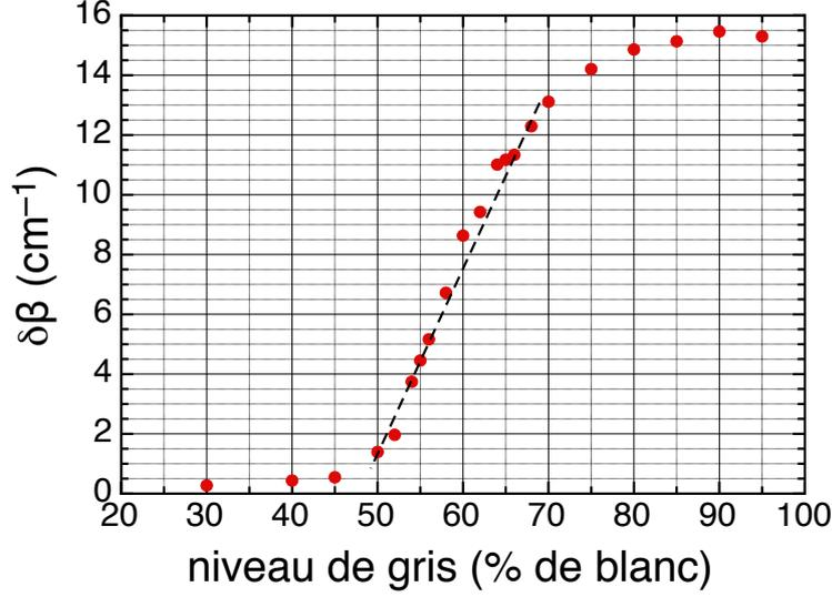
FIGURE 5.7 – Courbe de calibration obtenue par mesures interférométriques donnant la variation de la constante de propagation longitudinale en fonction du niveau de gris de l'image envoyée au SLM.
