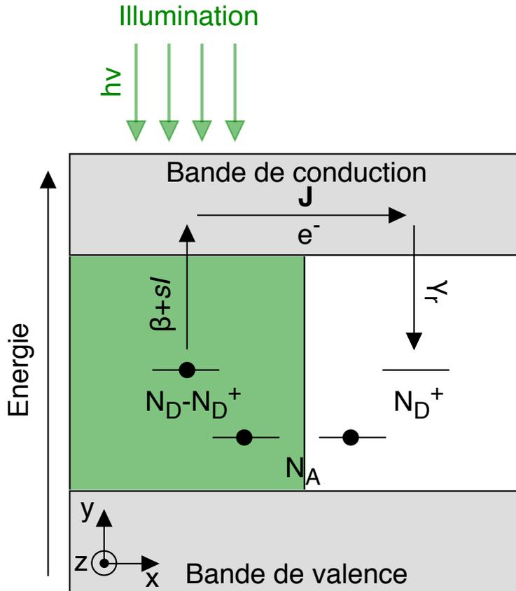
FIGURE 2.1 – Schéma simplifié du modèle de transport par bande. Dans une zone illuminée, un électron ( $e^-$ ) se trouvant sur un donneur non ionisé  $N_D - N_D^+$  est excité dans la bande de conduction créant un courant  $\mathbf{j}$ . Cet électron se désexcite ensuite dans une zone non illuminée (sombre) en se recombinant avec un donneur ionisé  $N_D^+$ .
