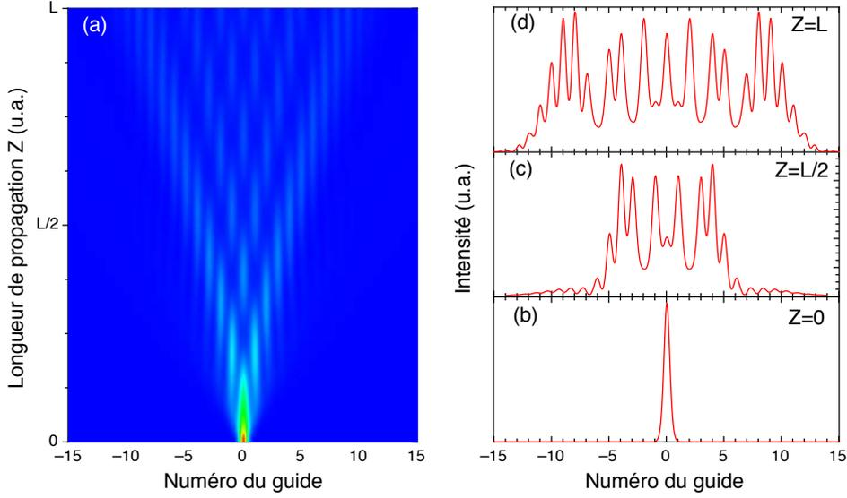
FIGURE 1.12 – Simulation de la propagation d'une onde dans une structure composée de 50 guides identiques (a). L'onde est initialement entièrement injectée dans le guide centrale (b). La distribution d'intensité au cours de la propagation (à la moitié de la structure (c) et à la fin (d)), n'est pas gaussienne contrairement à celle obtenue lors d'une propagation en milieu libre (diffraction). Ce phénomène est appelé diffraction discrète.
