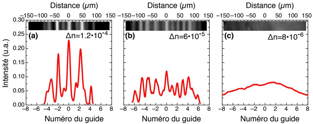
FIGURE 3.14 – Images expérimentales et profils d'intensité correspondants obtenus par imagerie de la face de sortie du cristal SBN long pour un réseau de périodicité  $\Lambda = 19.2 \mu\text{m}$  avec un contraste d'indice (a)  $\Delta n = 1.2 \cdot 10^{-4}$ , (b)  $\Delta n = 6 \cdot 10^{-5}$ , (c)  $\Delta n = 8 \cdot 10^{-6}$ . Les guides ont une largeur de  $12 \mu\text{m}$ . L'onde est entièrement couplée dans le guide central au départ.
