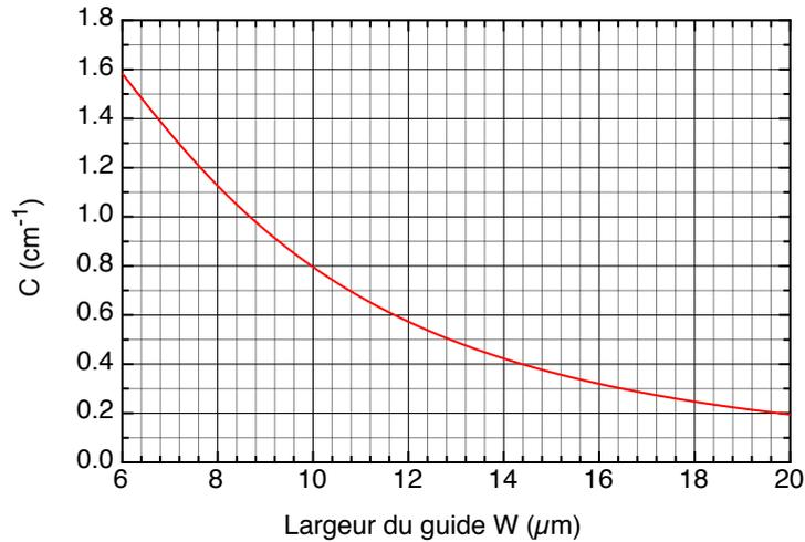
FIGURE 1.8 – Dépendance de la constante de couplage  $C$  avec la largeur des guides  $W$ . La longueur d'onde  $\lambda$  est de 633 nm, le contraste d'indice  $\Delta n$  est de  $2 \cdot 10^{-4}$  et la distance inter-guide  $s$  vaut 7  $\mu\text{m}$ .
