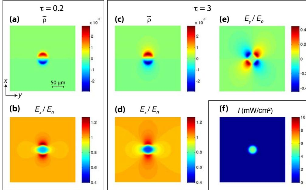
FIGURE B.2 – Dynamique d'établissement de l'effet photoréfractif pour une illumination circulaire 2D. Les mêmes grandeurs que celles de la Figure B.1 sont représentées et aux mêmes instants. Excepté la forme de l'illumination représentée en (f) tous les autres paramètres sont identiques à ceux de la Figure B.1.
