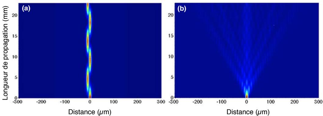
FIGURE 3.9 – Simulation BPM (Beam Propagation Method) de la propagation d'une onde lumineuse dans une structure composée de (a) deux guides et (b) un réseau de 100 guides. Le contraste d'indice vaut  $9 \cdot 10^{-5}$ , la largeur des guides est de  $7.2 \mu\text{m}$  et l'espace interguide vaut  $2.4 \mu\text{m}$ .
