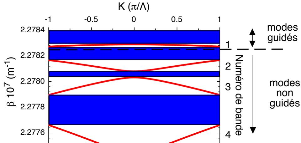
FIGURE 1.16 – Exemple de diagramme de bandes obtenu pour un réseau de guide de périodicité  $20 \mu\text{m}$ , avec une longueur d'onde de  $633 \text{ nm}$  et un contraste d'indice  $\Delta n = 1.5 \cdot 10^{-4}$ . Seules les quatre premières bandes sont représentées. Les parties colorées en bleu correspondent aux bandes interdites. Il est à noter que la numérotation des bandes est du bas vers le haut.
