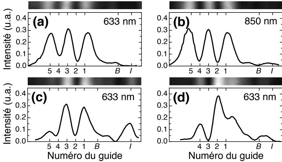
FIGURE 4.19 – (a,b) Profils d'intensité obtenus par imagerie de la face de sortie du cristal sur une caméra CCD, pour le cas  $N = 5$  avec une séquence contre-intuitive des constantes de couplage et à deux longueurs d'onde différentes ((a) : 633 nm et (b) 850 nm), (c) : cas d'un ordre intuitif et (d) cas d'un ordre contre-intuitif mais avec un nombre pair de guides dans le réseau.
