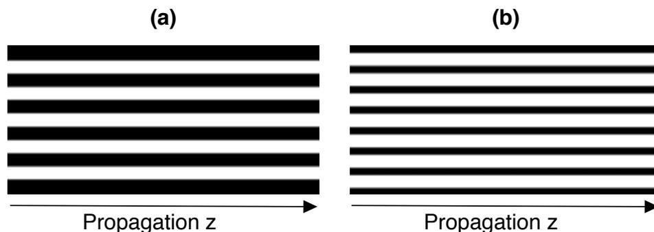
FIGURE 3.10 – Images envoyées au SLM pour la photo-inscription de deux réseaux de périodicité (a) 24  $\mu\text{m}$  et (b) 19.2  $\mu\text{m}$ . Dans les deux cas la largeur des guides est de 12  $\mu\text{m}$ .
