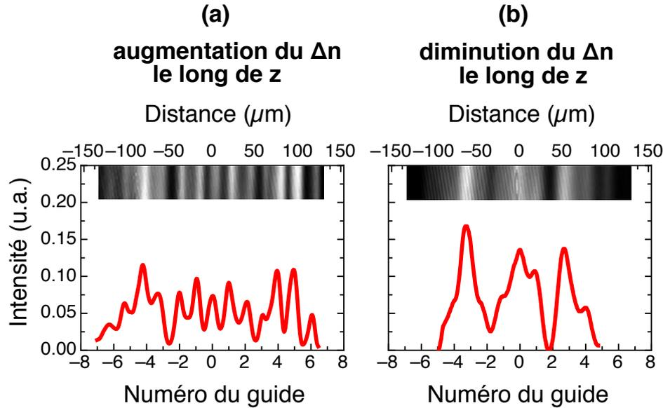
FIGURE 3.19 – Images expérimentales et profils d’intensité en sortie du cristal correspondant à une modulation linéaire longitudinale de  $\Delta n$  passant de (a)  $8 \cdot 10^{-6}$  à  $1.2 \cdot 10^{-4}$  et (b) de  $1.2 \cdot 10^{-4}$  à  $8 \cdot 10^{-6}$ . La période du réseau de guides est de  $19.2 \mu\text{m}$ . L’onde est entièrement couplée dans le guide central au départ.
