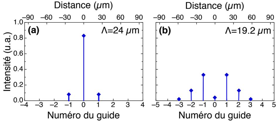
FIGURE 3.12 – Calculs de la répartition finale d’intensité après une propagation de 10 mm, égale à la longueur du cristal SBN court obtenue par la théorie des modes couplés avec (a)  $\Lambda = 24 \mu\text{m}$  (b)  $\Lambda = 19.2 \mu\text{m}$  et  $\Delta n = 1.2 \cdot 10^{-4}$ . L’intensité est discrétisée dans chaque guide. L’onde est entièrement couplée dans le guide central au départ.
