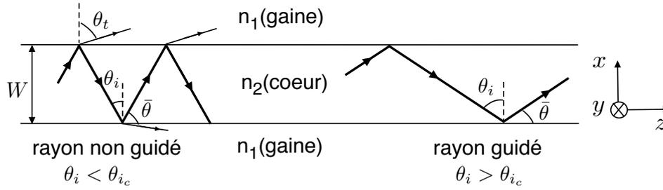
FIGURE 1.2 – Schéma de principe du confinement optique par réflexion totale dans le cas d'un guide plan diélectrique symétrique. Tous les rayons faisant un angle d'incidence  $\theta_i > \theta_{i_c}$  sont guidés.
