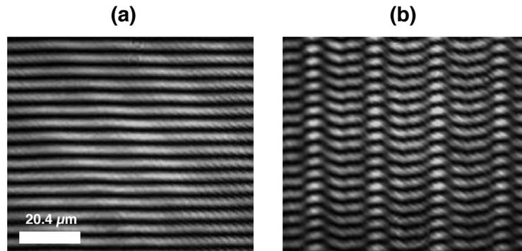
FIGURE 3.7 – (a) Interférogramme de référence et (b) interférogramme obtenu en inscrivant un réseau. En suivant le décalage des franges lors de la formation, on obtient une valeur pour le contraste d'indice engendré dans la structure.
