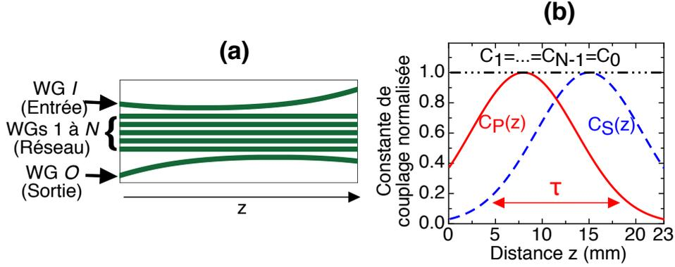
FIGURE 4.9 – (a) : Structure optique composée de guides d'onde couplés, (b) : dépendance longitudinale des constantes de couplages normalisées correspondantes.  $C_P(z)$  est la constante de couplage entre WG  $I$  et WG 1, tandis que  $C_S(z)$  est la constante de couplage entre WG  $N$  et WG  $O$ . La situation représentée ici correspond au cas intuitif.
