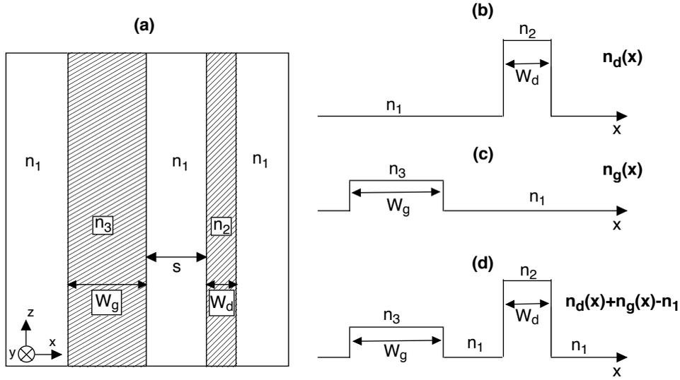
FIGURE 1.5 – Structure de principe composée de deux guides différents (a) et distribution d'indice pour les deux guides séparément (b,c) puis ensemble (d), correspondant à la structure représentée en (a)
