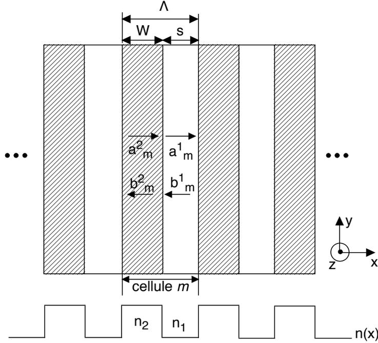
FIGURE 1.15 – Schéma de principe d'une structure périodique de période  $\Lambda$  composée de guides d'onde identiques. La largeur des guides est  $W$  et la distance inter-guide est  $s$ . La distribution d'indice de réfraction suivant  $x$  est également donnée. Cette structure est en tout point similaire à celle donnée au paragraphe précédent (Figure 1.10).
