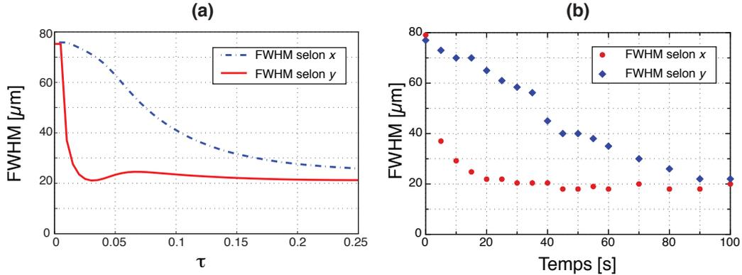
FIGURE B.7 – Evolution de la taille du faisceau sonde après propagation dans l'échantillon de 1 cm au cours de la mise en place du guide canal par illumination latérale avec  $I_2 = I_1 = 5 \text{ mW/cm}^2$  et  $E_0 = 3 \text{ kV/cm}$ . Le faisceau est focalisé sur la face d'entrée du cristal à l'endroit du guide. (a) Théorie. (b) Expérience.
