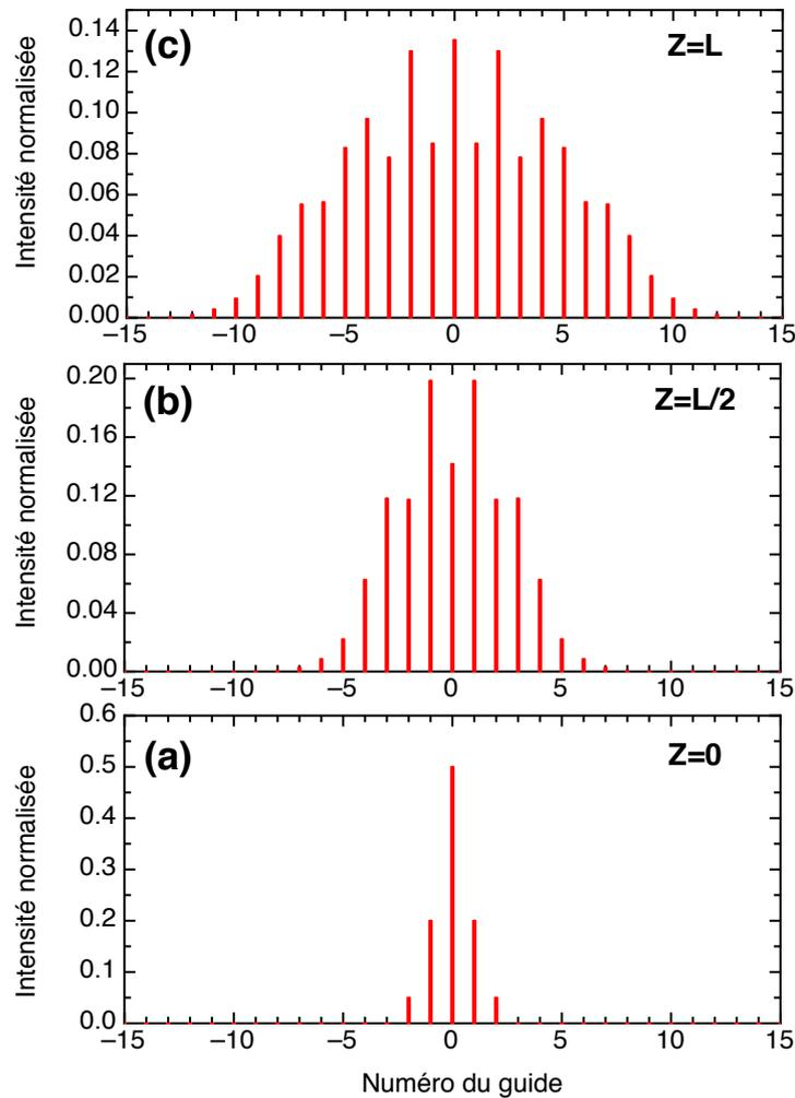
FIGURE 1.13 – Calculs de la répartition d’intensité obtenue par la théorie des modes couplés avec une structure composée de 50 guides identiques dans le cas où (a) l’onde est initialement injectée dans les 5 guides centraux suivant une distribution gaussienne. Les calculs sont réalisés pour une longueur de propagation de (b)  $z = L/2$  et (c)  $z = L$  où  $L$  est la longueur de propagation totale.
