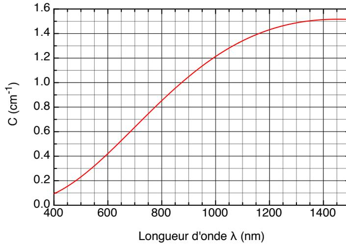
FIGURE 1.7 – Dépendance de la constante de couplage  $C$  avec la longueur d'onde  $\lambda$ . La largeur des guides  $W$  est prise égale à  $13 \mu\text{m}$ , le contraste d'indice  $\Delta n$  égal à  $2 \cdot 10^{-4}$  et la distance inter-guide  $s$  vaut  $7 \mu\text{m}$ .
