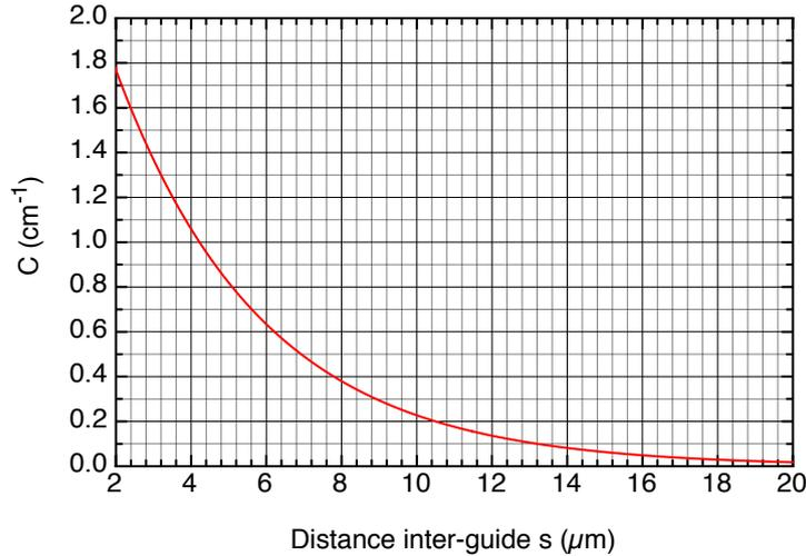
FIGURE 1.6 – Dépendance de la constante de couplage  $C$  avec la distance inter-guide  $s$ . La largeur des guides  $W$  est prise égale à  $13 \mu\text{m}$ , le contraste d'indice  $\Delta n$  égal à  $2 \cdot 10^{-4}$  et la longueur d'onde  $\lambda$  vaut  $633 \text{ nm}$ .
