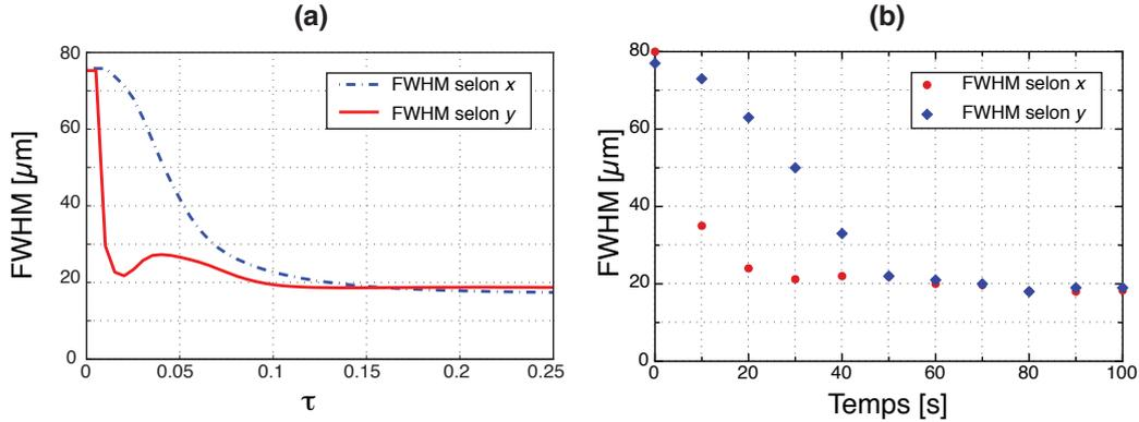
FIGURE B.9 – Evolution de la taille du faisceau sonde après propagation dans l'échantillon de 1 cm au cours de la mise en place du guide canal par illumination latérale avec  $I_2 = 2I_1 = 10 \text{ mW/cm}^2$  et  $E_0 = 5 \text{ kV/cm}$ . Le faisceau est focalisé sur la face d'entrée du cristal l'endroit du guide. (a) Théorie. (b) Expérience.
