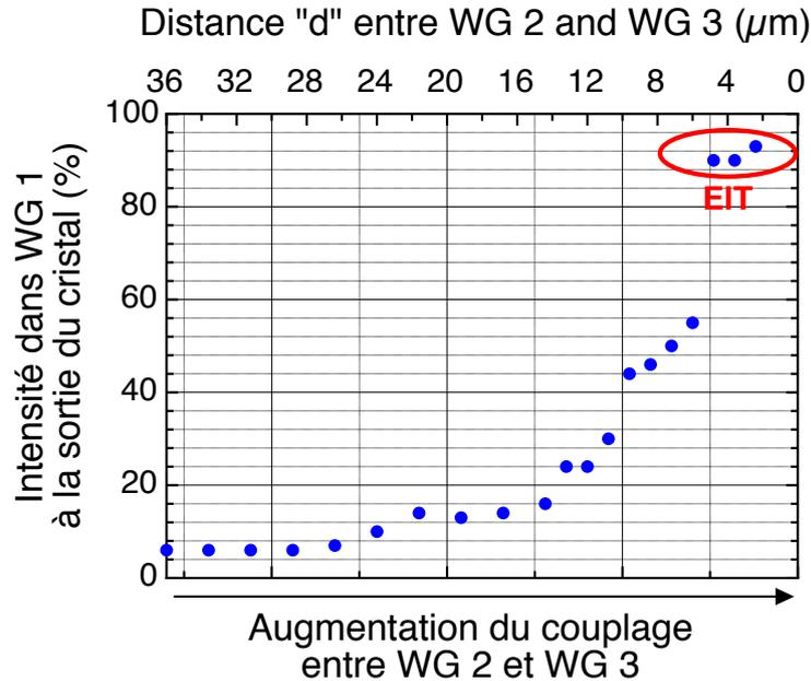
FIGURE 5.9 – Résultats expérimentaux démontrant l'analogie à l'EIT. L'intensité présente dans le premier guide à la sortie du cristal est tracée pour différentes valeurs de la distance  $d$  entre les guides 2 et 3 alors que la distance entre les deux premiers guides est constante et égale à  $13.2 \mu\text{m}$ .
