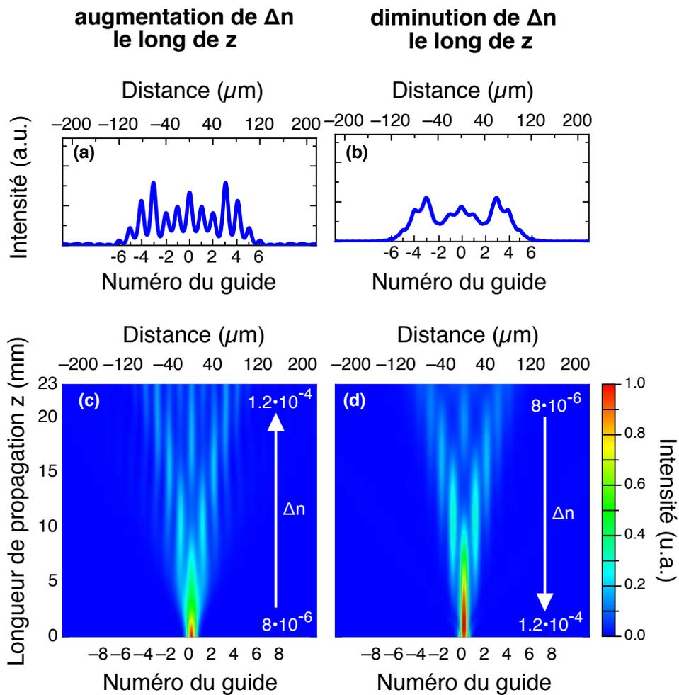
FIGURE 3.20 – Simulations BPM de la propagation d'une onde dans un réseau de guide où le contraste d'indice est modulé linéairement le long de la propagation de (a)  $8 \cdot 10^{-6}$  à  $1.2 \cdot 10^{-4}$  et (b) de  $1.2 \cdot 10^{-4}$  à  $8 \cdot 10^{-6}$ . La période du réseau est de  $19.2 \mu\text{m}$  et la longueur de propagation est de  $23 \text{ mm}$ . L'onde est entièrement couplée dans le guide central au départ.
