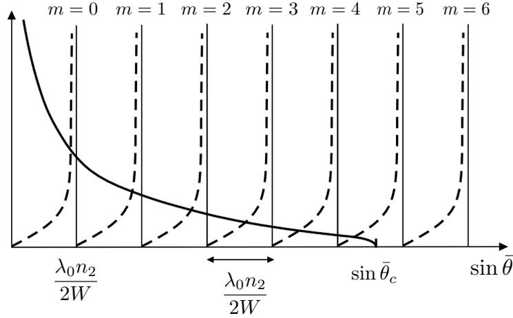
FIGURE 1.3 – Représentation graphique de l'éq. (1.9) pour la détermination des valeurs de l'angle  $\bar{\theta}_m$  des modes du guide. La courbe en trait plein représente  $\tan \frac{\varphi_r}{2}$  tandis que les courbes en traits pointillés représentent la tangente de l'éq. (1.9) pour différentes valeurs de  $m$ . Les intersections des deux courbes donnent les différentes valeurs de  $\bar{\theta}_m$  et le nombre d'intersections donne le nombre total de modes pouvant se propager.
