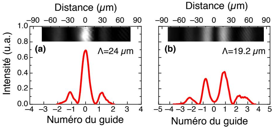
FIGURE 3.11 – Images expérimentales et profils d'intensité correspondants obtenus par imagerie de la face de sortie du cristal SBN court (propagation de 10 mm) pour un réseau de périodicité (a)  $\Lambda = 24 \mu\text{m}$  (b)  $\Lambda = 19.2 \mu\text{m}$  avec un contraste d'indice  $\Delta n = 1.2 \cdot 10^{-4}$ . Les guides ont une largeur de  $12 \mu\text{m}$ . L'onde est entièrement couplée dans le guide central au départ.
