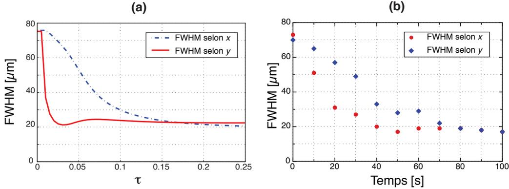
FIGURE B.8 – Evolution de la taille du faisceau sonde après propagation dans l'échantillon de 1 cm au cours de la mise en place du guide canal par illumination latérale avec  $I_2 = 2I_1 = 10 \text{ mW/cm}^2$  et  $E_0 = 3 \text{ kV/cm}$ . Le faisceau est focalisé sur la face d'entrée du cristal l'endroit du guide. (a) Théorie. (b) Expérience.
