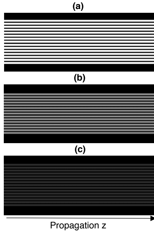
FIGURE 3.13 – Images envoyées au SLM pour la photo-inscription des trois réseaux de période 19.2 \mu\text{m} et de contraste d'indice (a) 1.2 \cdot 10^{-4} , (b) 6 \cdot 10^{-5} et (c) 8 \cdot 10^{-6} . La variation du contraste d'indice est obtenue par variation du niveau de gris des bandes dans les images envoyées au SLM.
