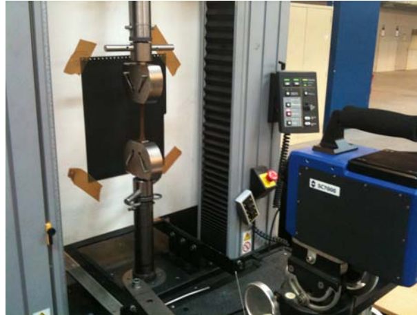
FIGURE 3.6.6 – Configuration machine lors d'essai de traction uniaxiale avec enregistrement de la variation de température
