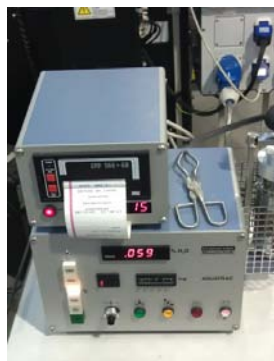
FIGURE 3.3.3 – Photographie de l'appareil utilisé pour la mesure de l'humidité
