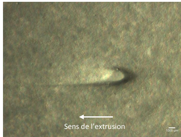
Figure I.31 : Micrographie d'un défaut type « pointe de flèche » (Bessin, Jumeau 2012).
