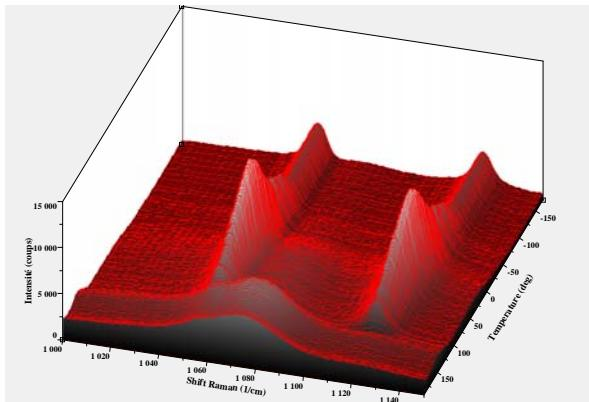
Figure 2 : Cartographie en température du grade A.
