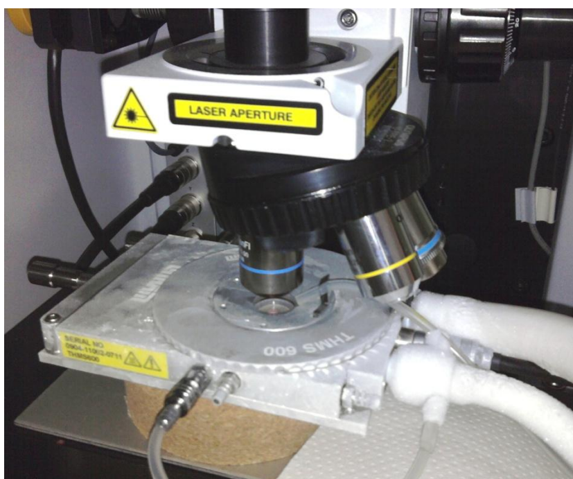
Figure III.14: Photo du montage Raman-Température au sein de l'Aramis.
