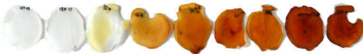
Figure IV.41 : Photographie de quelques disques de PEBD oxydés à 150 °C dans l'étuve entre 10 et 591 h (de la gauche vers la droite).
