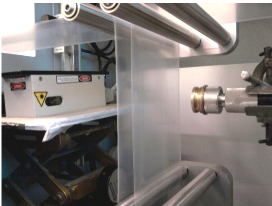
Figure VI.1 : Montage trans-Raman sur film.
