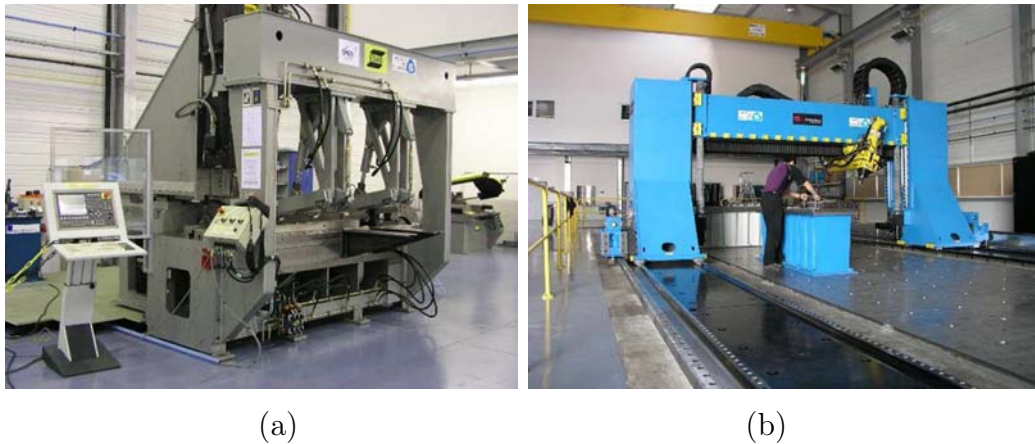
FIGURE 1.1 – Machines de soudage FSW de l’Institut de Soudure (Metz) (a)- Machine ESAB. (b)- Machine MTS
