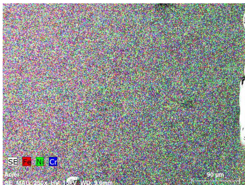
Fig.A-6 : Cartographie chimique d'un acier 301L
