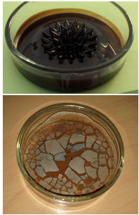
Fluide magnétorhéologique soumis au champ magnétique d'un aimant, et séchage d'un mélange de ce fluide avec environ 5% de silice.
