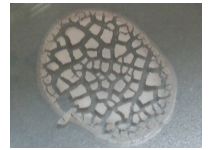
Séchage d'un gel PNIPAAm 5%, Aerosil 5%.
