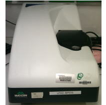
Appareil Zetasizer ® Nano ZS utilisé pour la mesure de potentiel \zeta .
