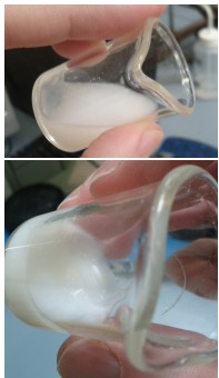
Gel PNIPAAm 5%, Aerosil 5%, à température ambiante (en haut) et à environ 40°C (en bas).
