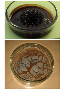
Fluide magnétorhéologique soumis au champ magnétique d'un aimant, et séchage d'un mélange de ce fluide avec environ 5% de silice.
