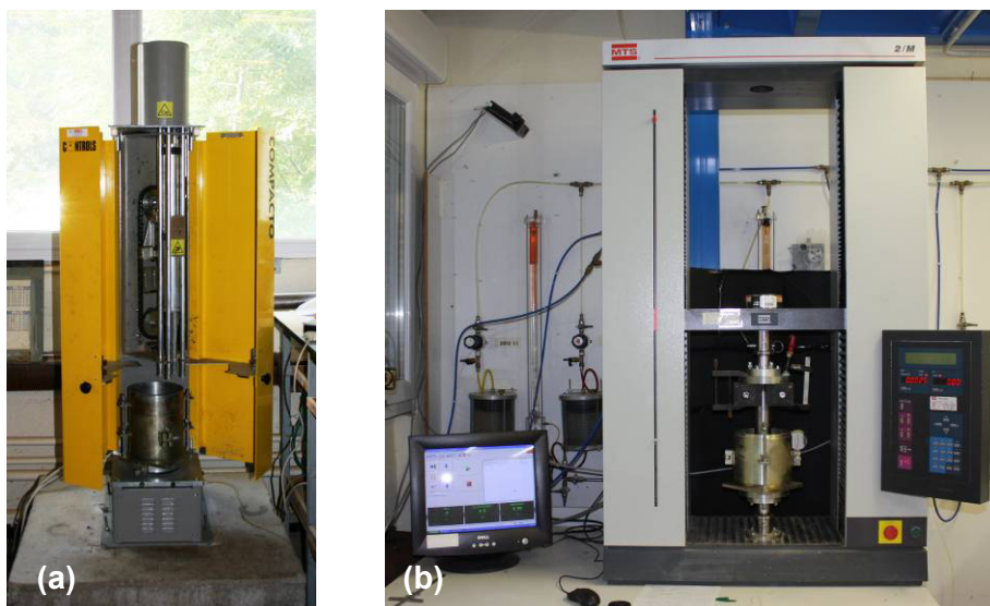
Figure II.1 : Damme Proctor automatique et moule CBR positionné (a), dispositif de mesure de la portance (b).
