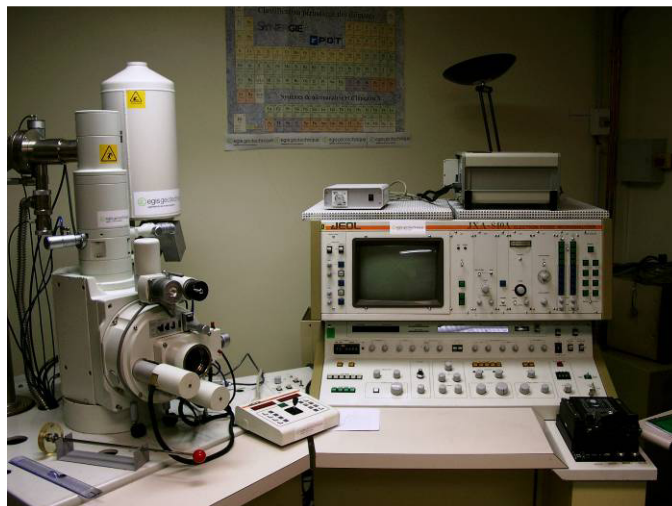
Figure II.3 : Dispositif de microscopie électronique à balayage.
